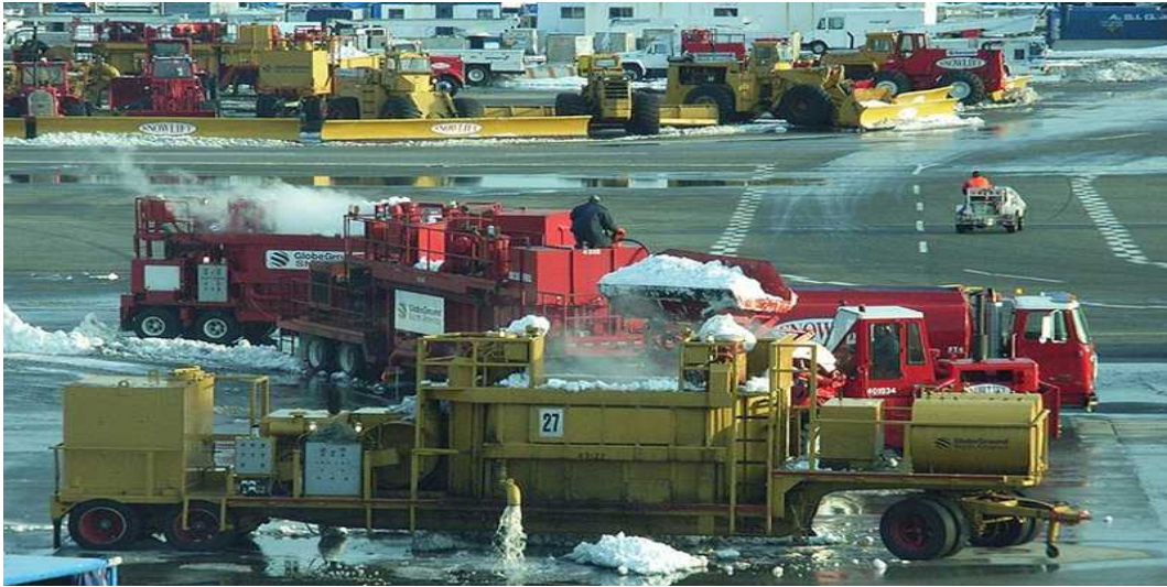
<그림 2-1> 미국 JFK 공항 활주로 제설작업 용 snow melter (2006)
