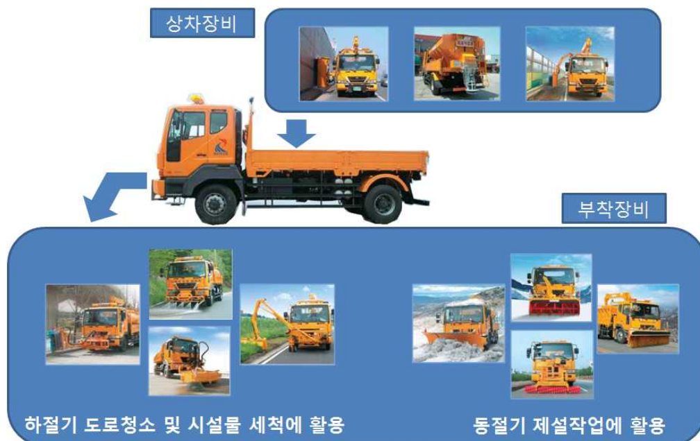
<그림 2-10> 다목적 도로관리 차량의 구성
