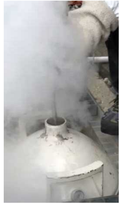
Fig. 2-다-4) 18. 생산된 LNG를 End Flash Drum에서 부터 받는 사진
