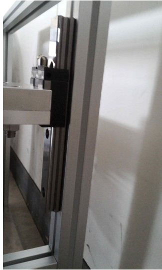
Fig. 8 현가장치 연결 부 리니어가이드 설치
