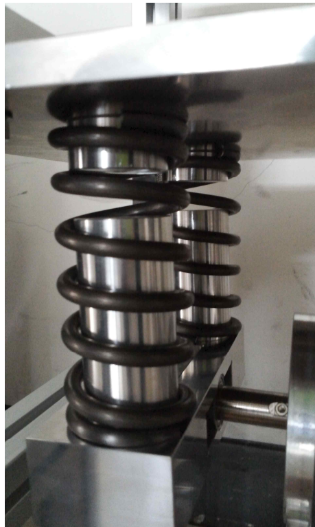
Fig. 9 1차 현가장치 설치
