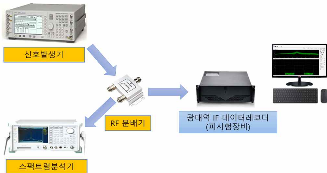
그림 6.6 IF 데이터레코더 시험평가 장비 구성 (예)
