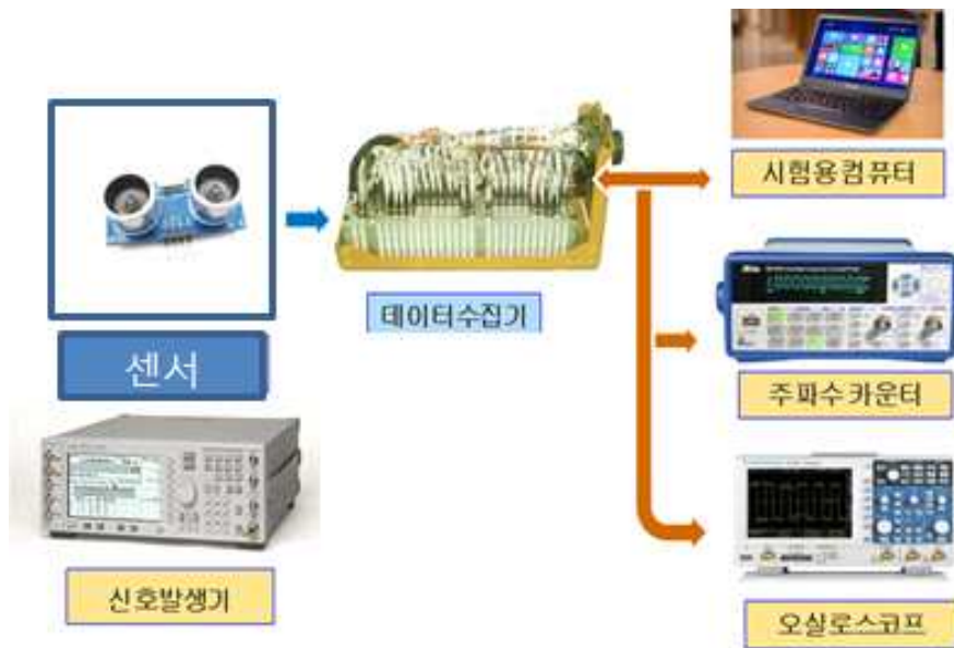
그림 2.3 데이터수집기를 이용한 센서 시험평가 장비 구성 (예)
