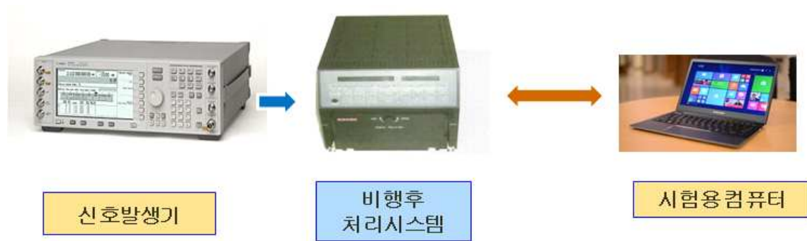
그림 6.7 비행후 데이터처리시스템 시험평가 장비 구성 (예)
