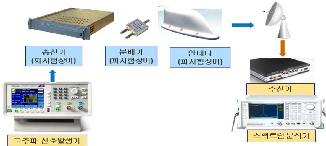
그림 3.11 T-50 TTS-6335 송신기 시험평가 장비 구성 (예)
