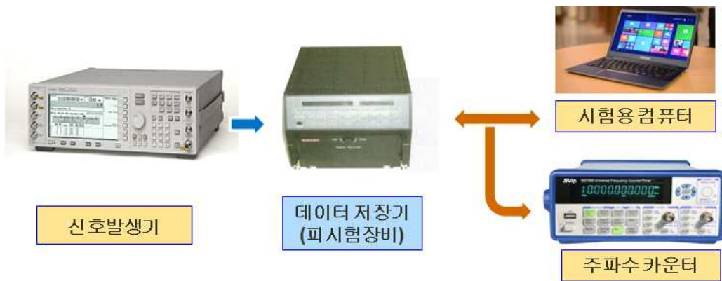
그림 3.9 비디오 저장장치 시험평가 장비 구성 (예)
