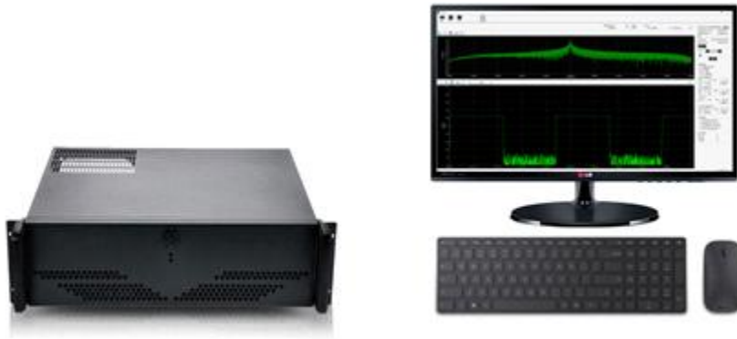
그림 4.7 IF/RF 광대역 데이터레코더 시제품 형상
