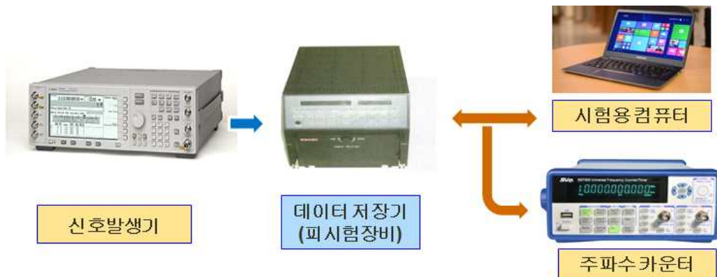
그림 6.4 비디오 저장장치 시험평가 장비 구성 (예)
