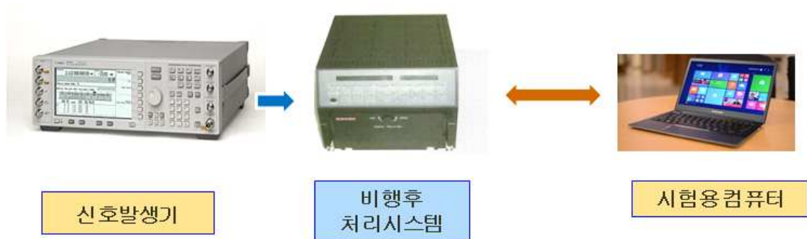
그림 4.6 비행후 데이터처리시스템 시험평가 장비 구성 (예)
