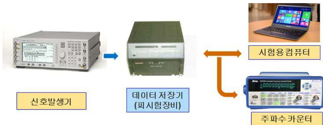
그림 3.5 데이터 저장장치 시험평가 장비 구성 (예)
