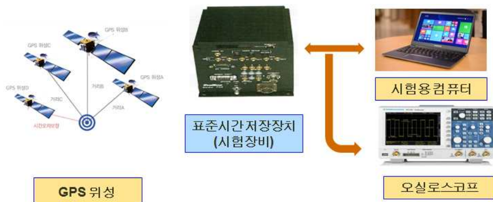
그림 3.7 T-50의 GPS-705 시간부호발생기 시험장비 구성 (예)
