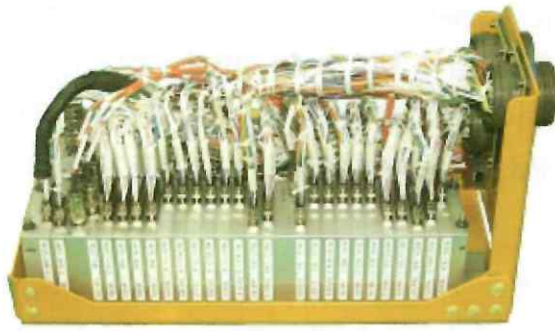
그림 3.2 T-50 데이터 수집기 조립 모습(PCM Tray)
