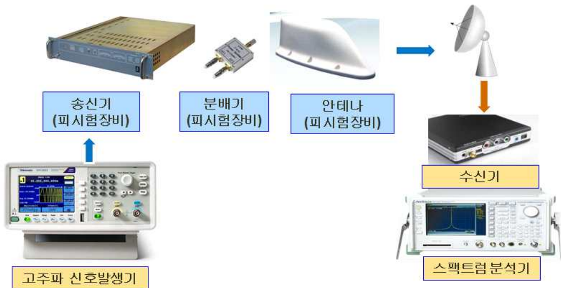
그림 6.5 송신기 시험평가 장비 구성 (예)
