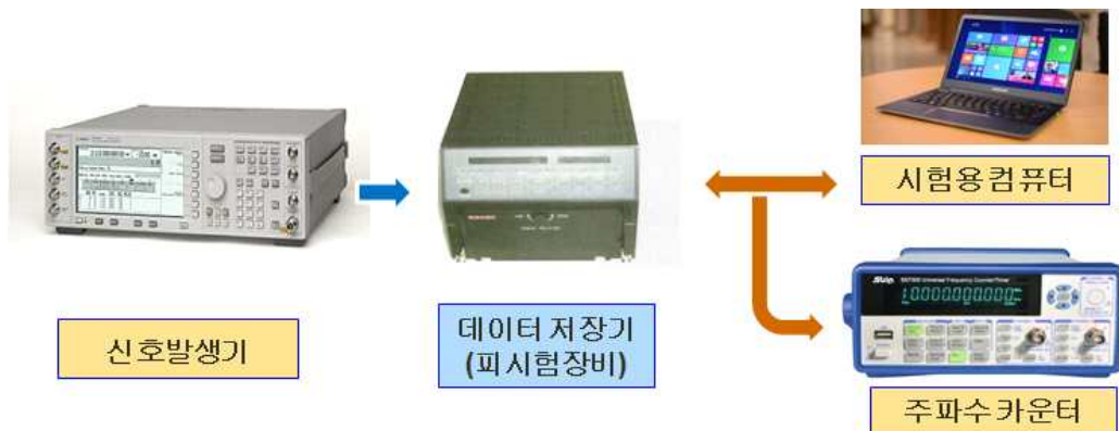
그림 6.2 데이터 저장장치 시험평가 장비 구성 (예)
