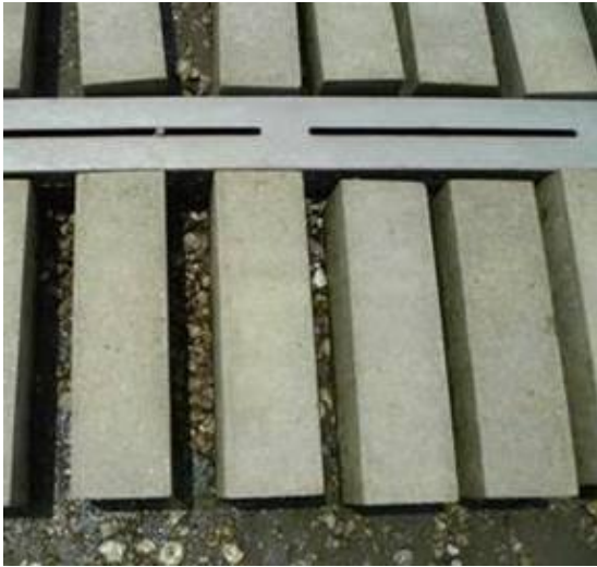
<그림 3.20> 해양환경 노출을 통한 콘크리트의 6가크롬 침출시험
