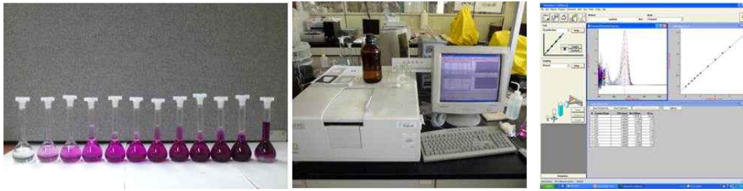
〈그림 3.19〉 콘크리트/모르타르 시편의 6가크롬 함유량 측정 및 처리장 내의 수서환경에서의 6가크롬 측정을 위한 Spectrophotometry
