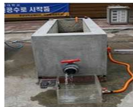
자연정화를 통한 알칼리이온 침출 저감 및 전기 방식 적용 후의 결과
