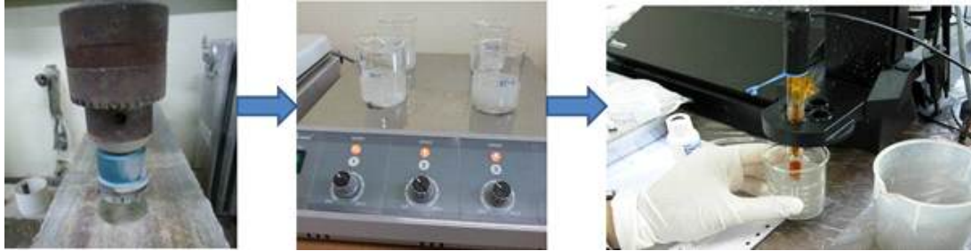
<그림 3.48> pH 프로파일링을 위한 표면분말 채취, Suspension 제조 및 pH 측정
