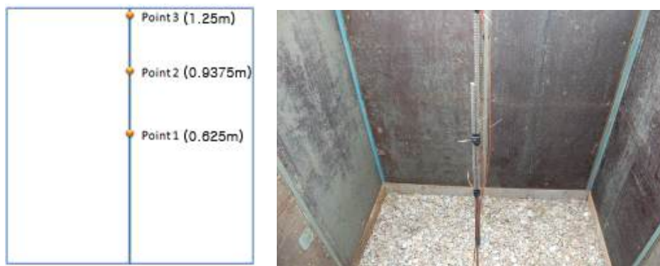
< 그림 3.61 > 수화온도 측정을 위한 열전대 설치 위치
