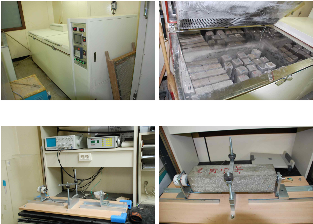
< 그림 3.26 > 동결융해 시험
