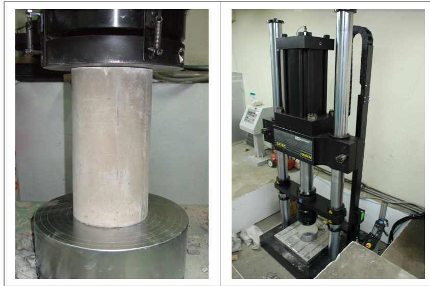
< 그림 3.22 > 콘크리트 압축강도 시험
