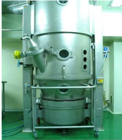
< 그림 3.14 > 유동층 공정 방식 마이크로 캡슐 제조 장치
