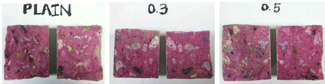
< 그림 3.58 > MCR 적용 탄산화 깊이 측정 사진
