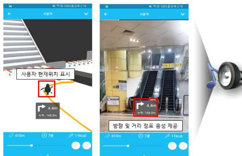
그림. 실내위치측위 기반의 사용자 위치 표시 및 AR/TTS 서비스 제공
