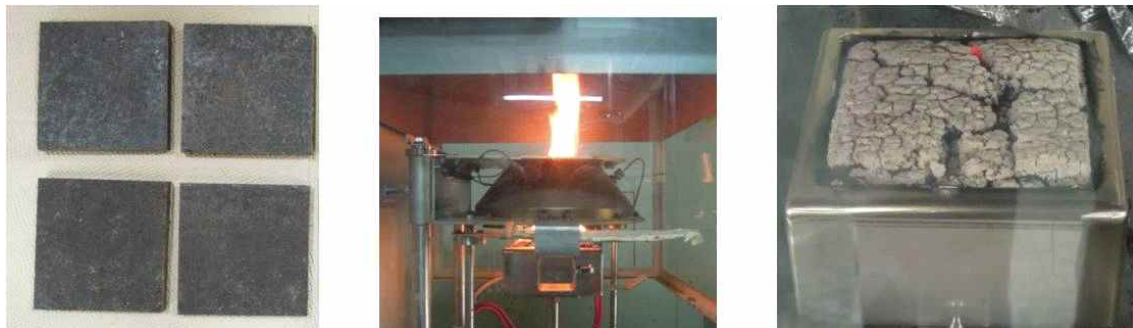
그림 44 콘칼로리미터 시험 과정
