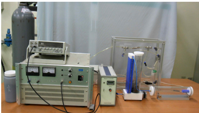
그림 9 상온상압 플라즈마 lab scale 장치 제작
