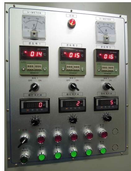
그림 30 Twin Screw Extruder 조작판넬
