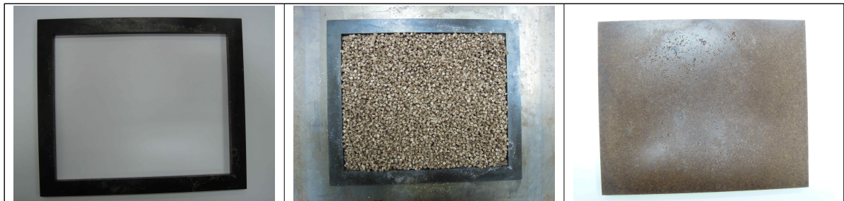
그림 36 판형 복합재 제작과정
