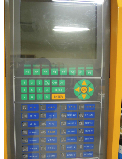
그림 32 Injection Molding Machine 조작판넬
