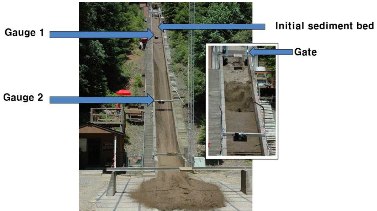
그림 11. 토석 댐 개방 후 토석 높이의 시계열 분석을 위한 모형실험 수조 (Iverson et al., 2010).
