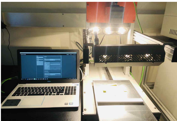
그림 3-1-6. 초분광카메라 개략도 및 시험 구성
