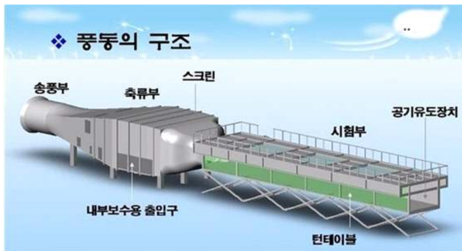
<그림 79> Top-view of the 4.5x2.5x25m open-type low speed wind tunnel.
