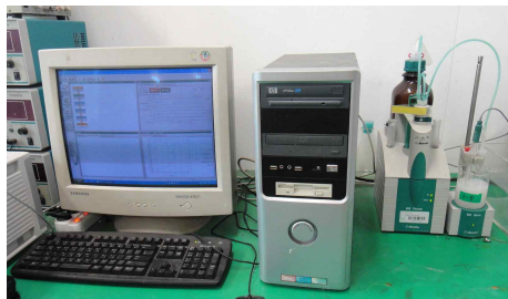
<그림 3.23> 염화물량 정량 분석 실험 측정광경 및 정량분석 플로우
