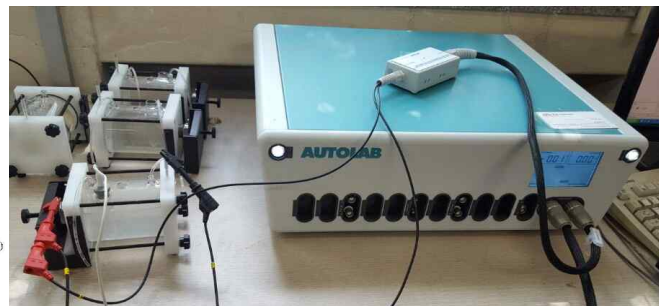
(c) Potentiostat을 이용한 전기화학 부식실험
