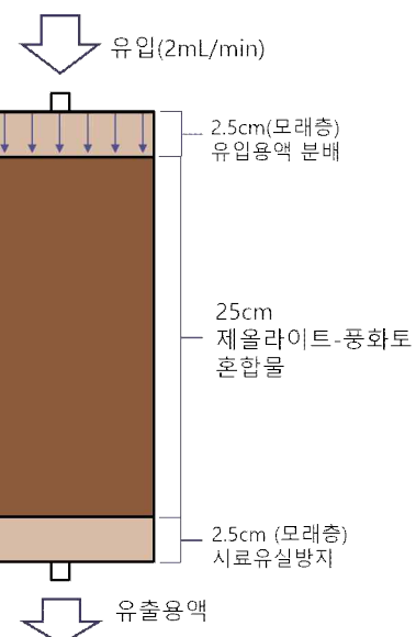
<제올라이트-풍화토 혼합물 컬럼시험 사진 및 개요도>
