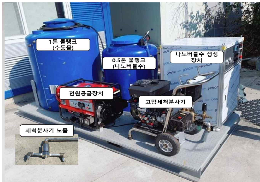
<4HP 이하 80L/min 이상급 미세기포 세척장치>
