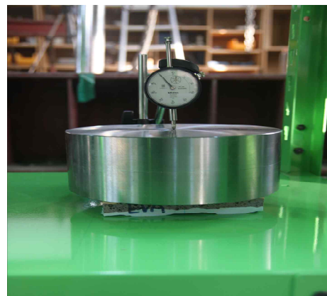
[그림 3.2.3.e] 장기변형 250N 가력 실험체 각각의 Setting 사진
