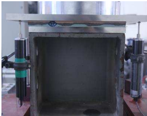
[그림 3.1.3.c] 만능시험기를 사용하여 실험체 가력
