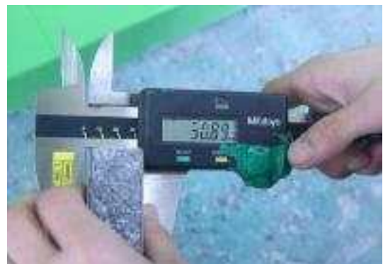
[그림 3.6.3.c] 디지털 버니어 캘리퍼스를 이용하여 두께 측정
