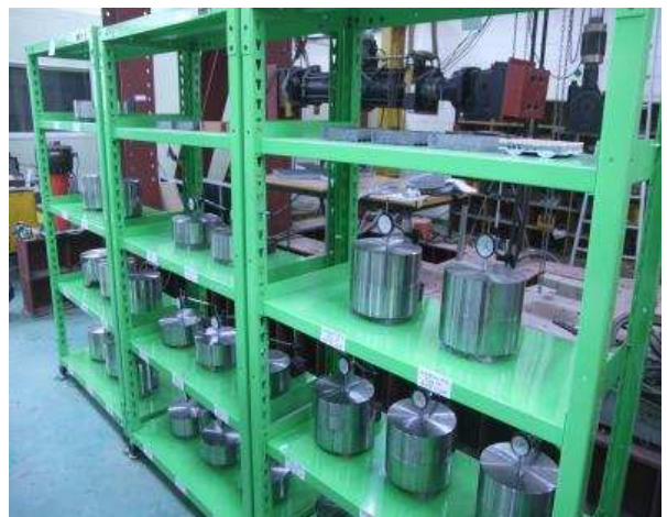
[그림 3.2.3.d] 장기변형 Setting 완료 사진
