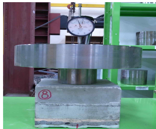
[그림 3.3.3.c] 바닥온돌층 장기변형 250N 가력 실험체 각각 Setting 사진
