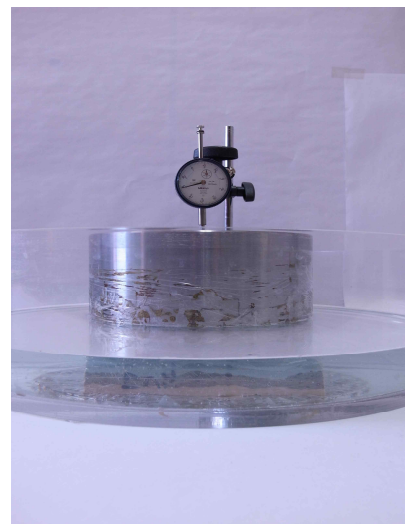
[그림 3.4.3.b] 완충재 침수 후, 장기변형 250N 가력 실험체 각각 Setting 사진
