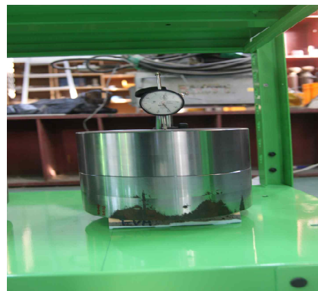
[그림 3.2.3.f] 장기변형 500N 가력 실험체 각각의 Setting 사진
