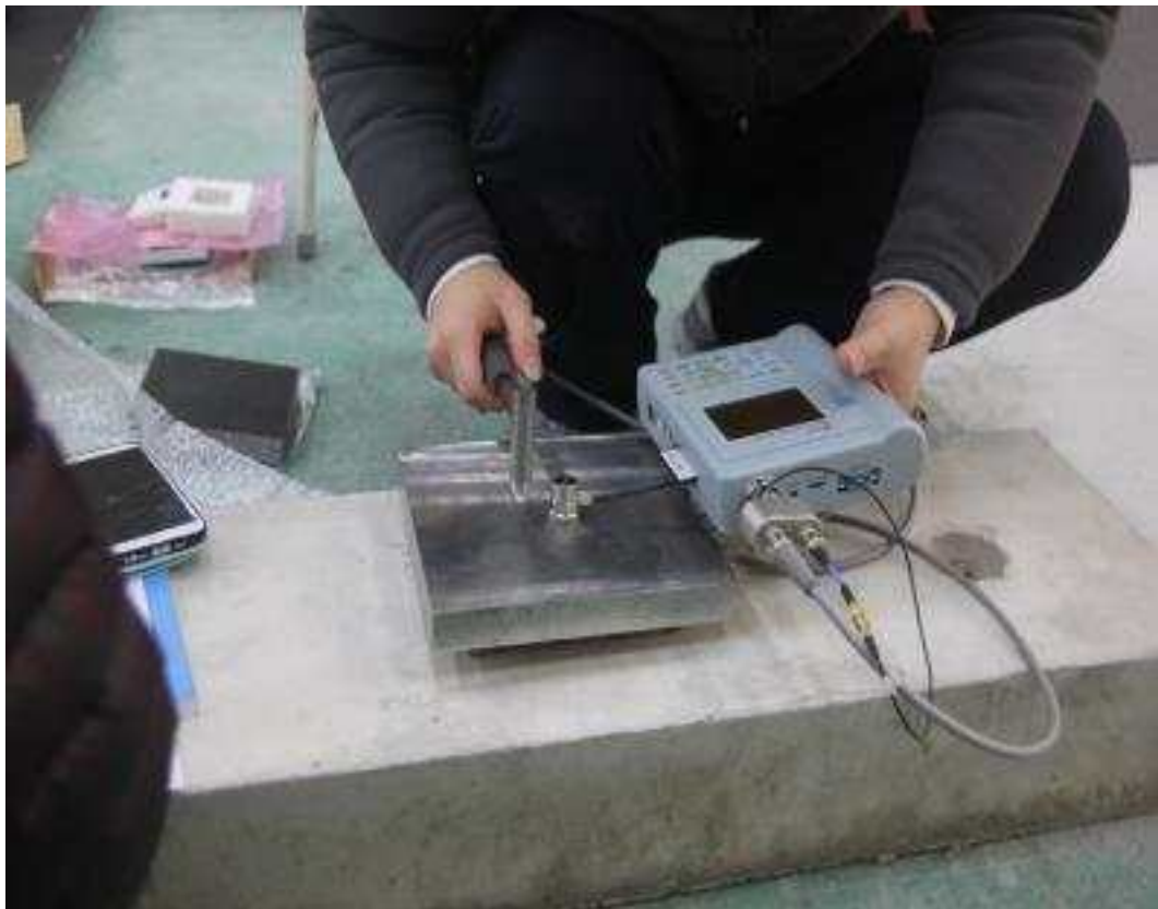
[그림 3.5.3.f] 동탄성계수, 손실계수 계산을 위한 FFT분석기 실험
