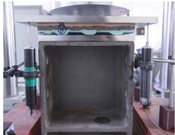
[그림 3.1.3.b] 상단 400mm×400mm 철판 Setting 후 가력 전
