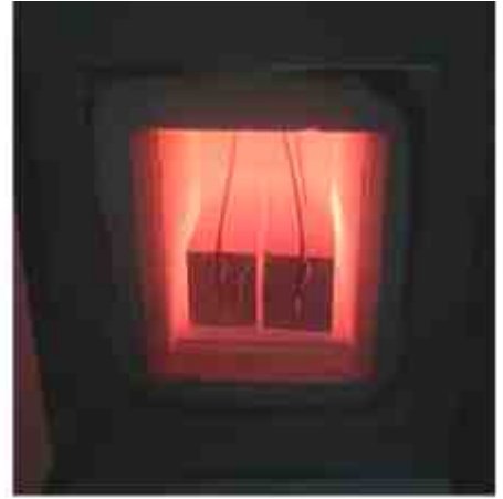
그림 3.5.1 탄산화 피해수준 조사용 샘플의 전 처리 모습
