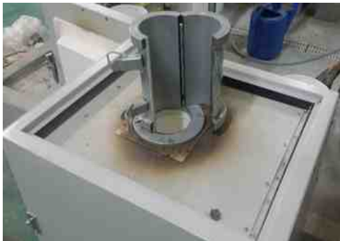
c. 강제 철재몰드가 설치된 모습 (가열로 상부)
