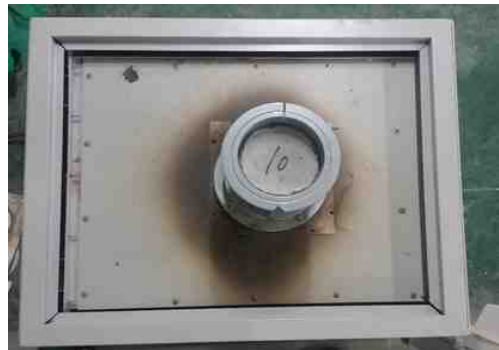
d. 원주형 공시체를 철재몰드로 결속시킨 모습 (가열로 상부)
