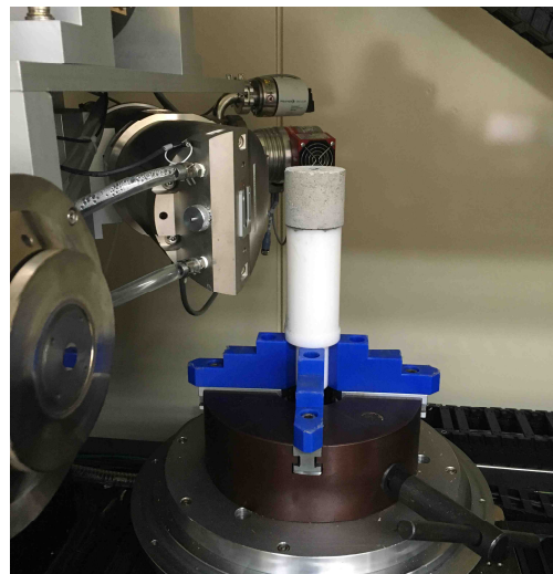
b. X-ray CT를 이용한 샘플 측정 모습
