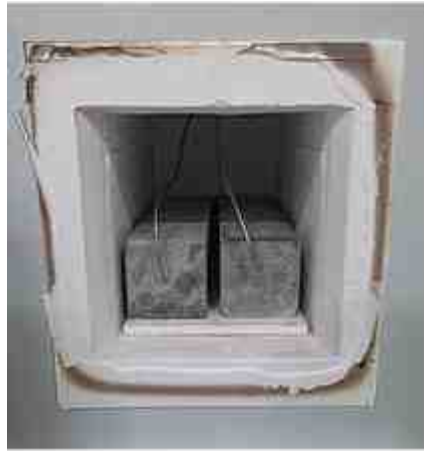
그림 3.5.1 탄산화 피해수준 조사용 샘플의 전 처리 모습
