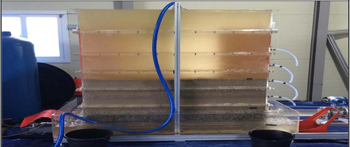
소형 Pilot 장치 - 혼합여재 Case 2 실험 전경
