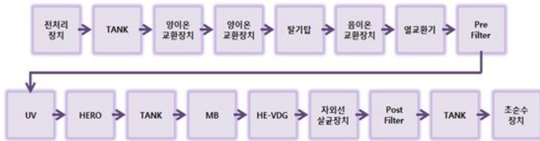
[그림 2-12] HERO system을 포함하는 NOMURA 社の 순수 개발 공정도(예시)
