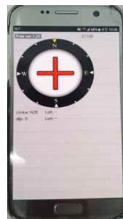
그림 3.20 Joint orientation test apparatus
