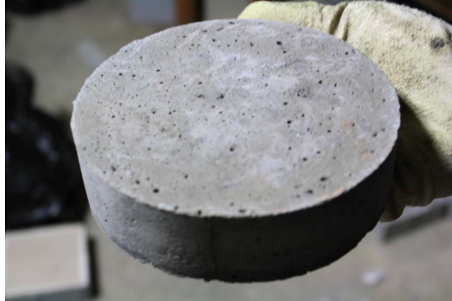
그림 2.2.3 물흡수계수 측정용 시험체 (KS F 4716)
