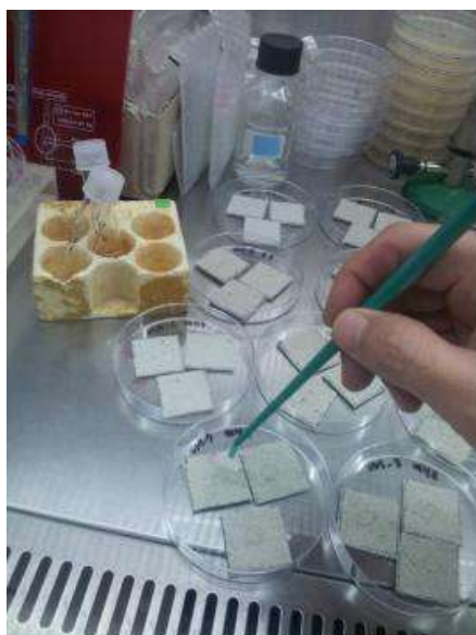
그림 2.2.12 시료에 균을 접종하는 모습
