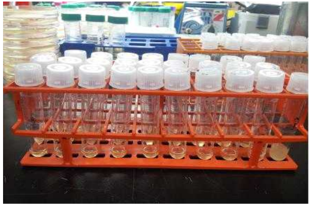
그림 2.2.80 대장균에 대한 항균성 실험 결과. 맨오른쪽이 대조군 시료
