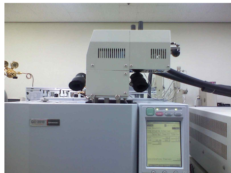
그림 2.2.168 Purge & Trap analyzer
