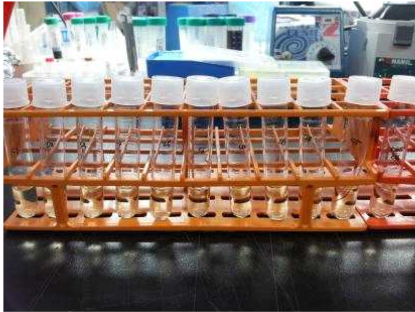
그림 2.2.86 UV-a를 조사하지 않은 시료의 세균 배양 후 불검출 모습
