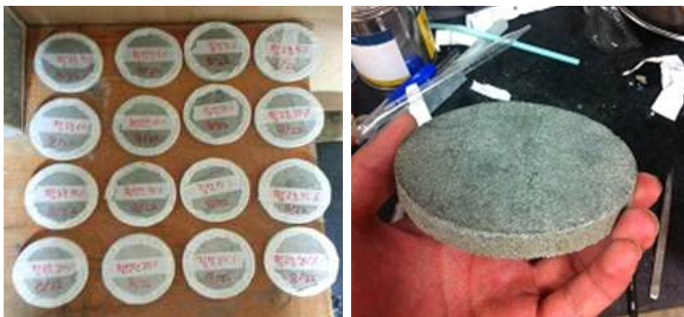
그림 2.2.2 물흡수계수 측정용 시험체 (KS F 4715)
