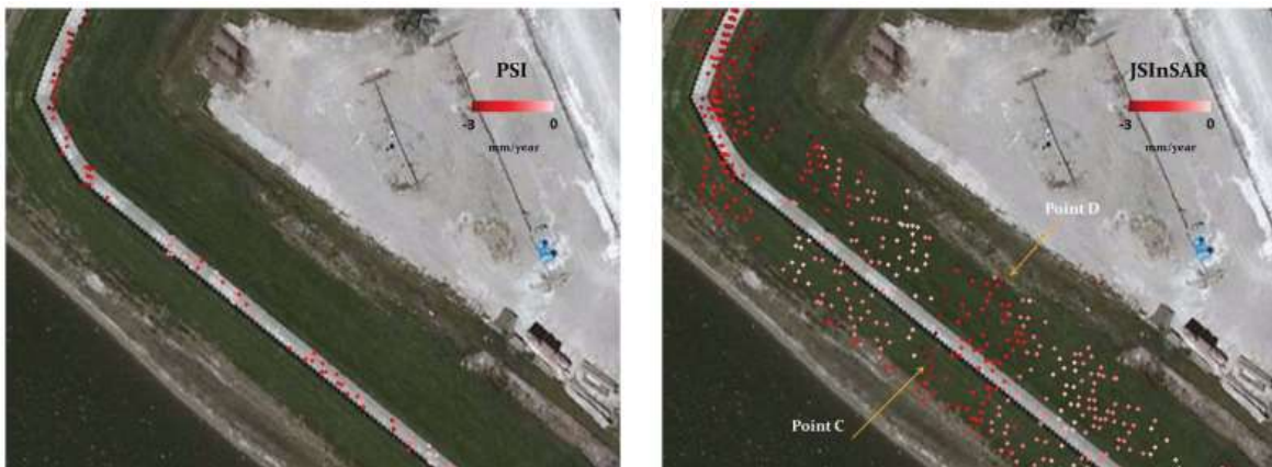
[그림 19] 고정산란체 기반 시계열 지표변위 관측 기법을 활용한 제방 지표변위 관측 결과
