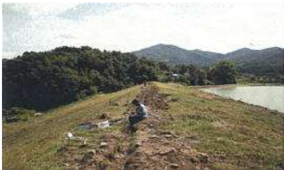
(a) 전극 및 케이블 설치
