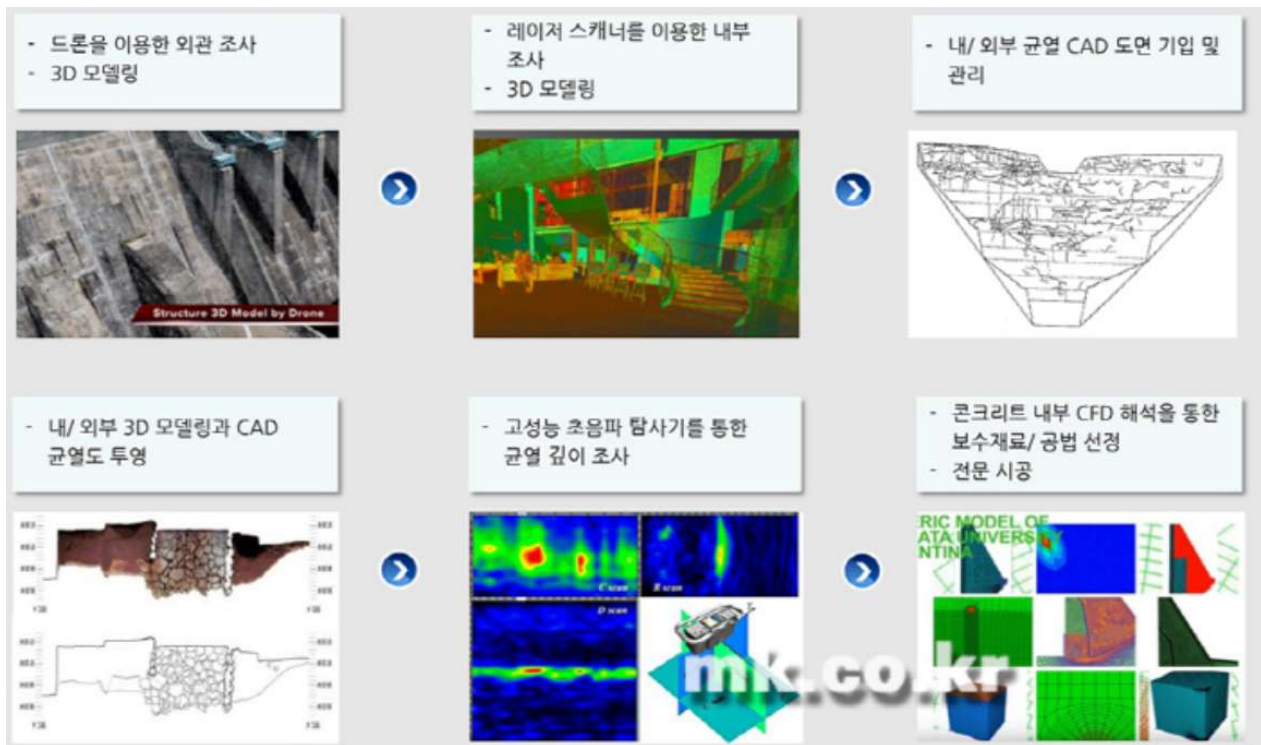
[그림 49] 무인기 활용 댐 안전진단 방법(대우건설 기술연구원)
