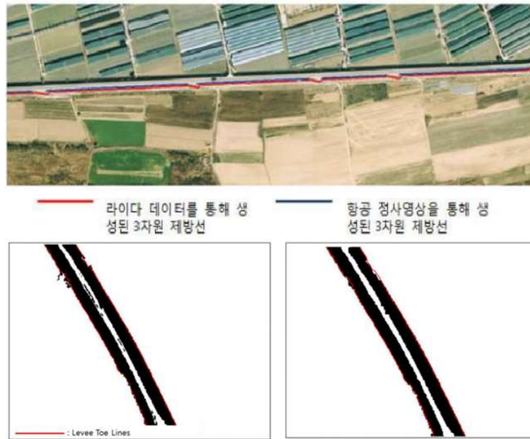
[그림 44] 항공 LiDAR 자료와 항공 영상을 활용한 제방 매핑 예시 ((주)지오씨엔아이, 2011;
