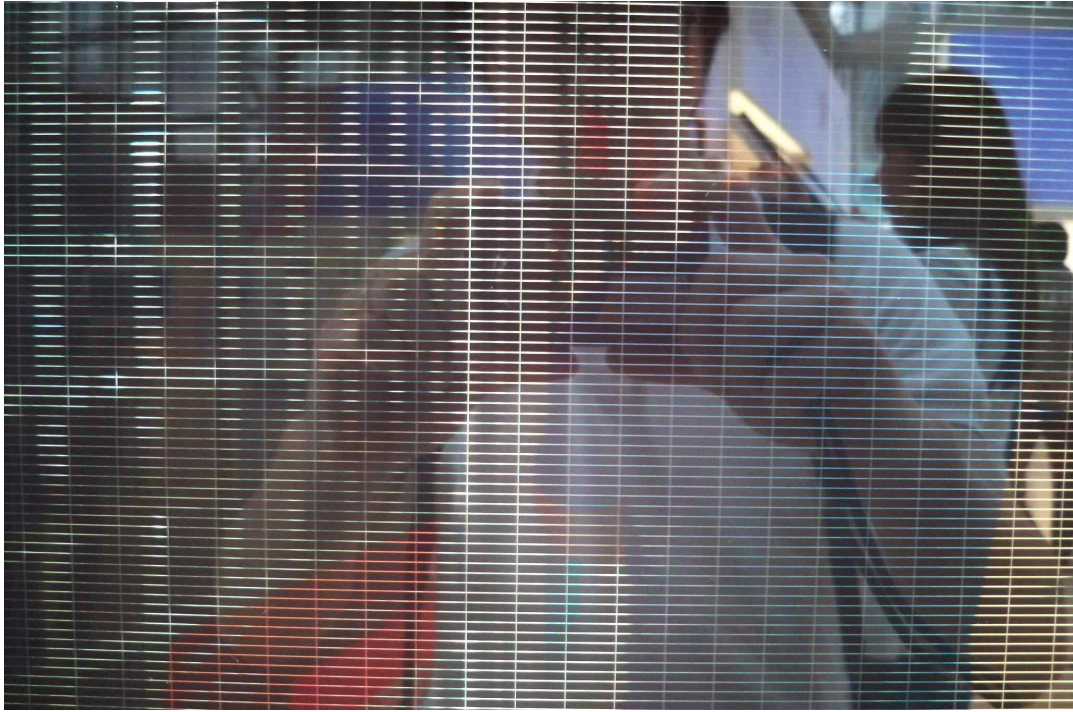
실제 비정질 박막 실리콘 BIPV 모듈의 레이저 스크라이빙 된 모습
