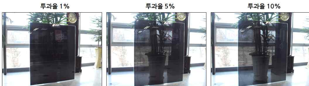
투과율별 a-Si BIPV모듈의 모습
