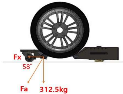
(그림. 8) Tire에 의한 Outer Pipe 하중 계산
