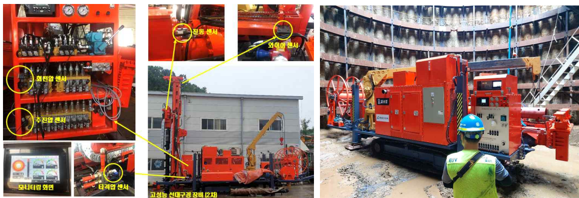
천공속도 및 타격압 모니터링 및 무선리모컨을 이용한 천공속도 및 압력 제어
