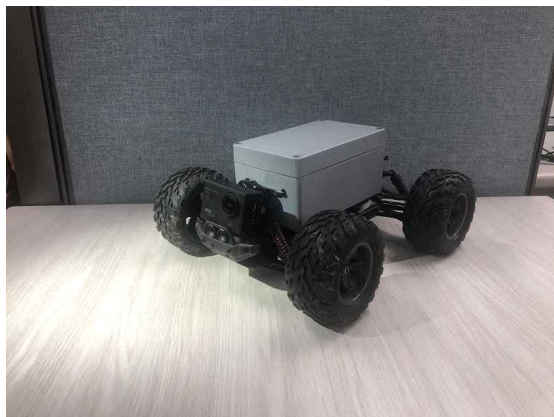
차량형 테스트 제품 제작(1차 시제품) 내벽 지지형 천공 홀 내부 계측 장비 설계(2차 시제품) 천공 홀 내부 계측 장비 시제품 설계 및 개발
