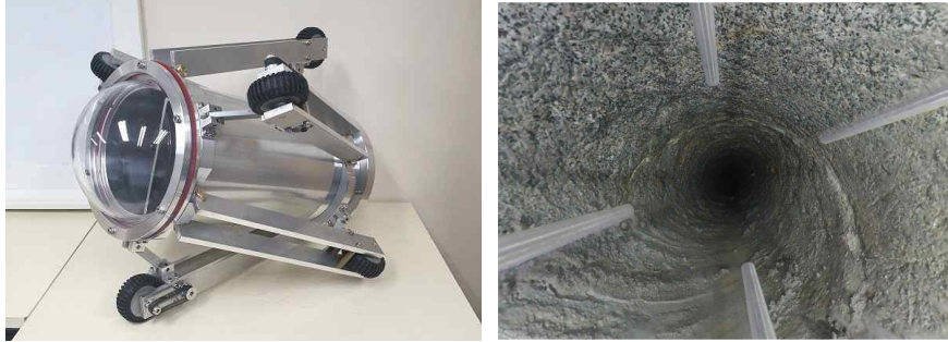
천공 홀 내부 계측장비 및 홀 내부 관측 이미지
