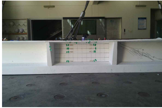
(a) Specimen #1 시험체 파괴모드 (전단+압축플랜지 파괴)
