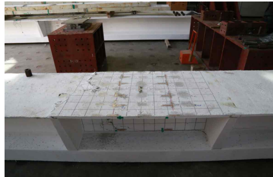
(c) Specimen #3 시험체 파괴모드 (플랜지 압축 파괴)
