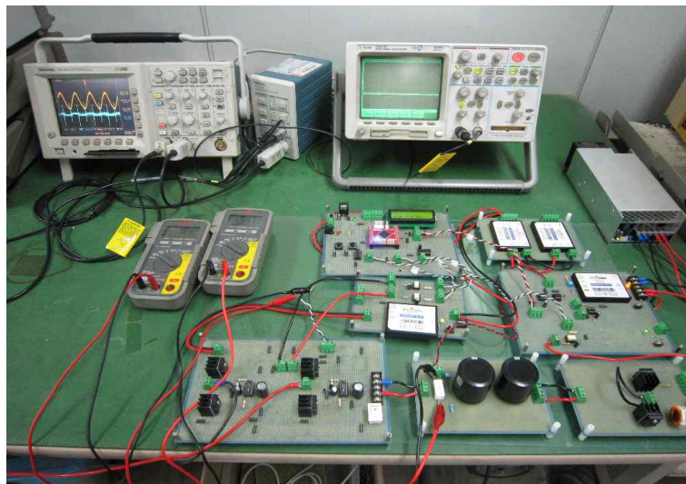
그림 3.153 PVDF film Actuator 구동용 파워 드라이버 실험 환경
