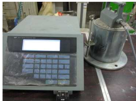
(b) 시료 성형완료 및 열특성 측정모습
