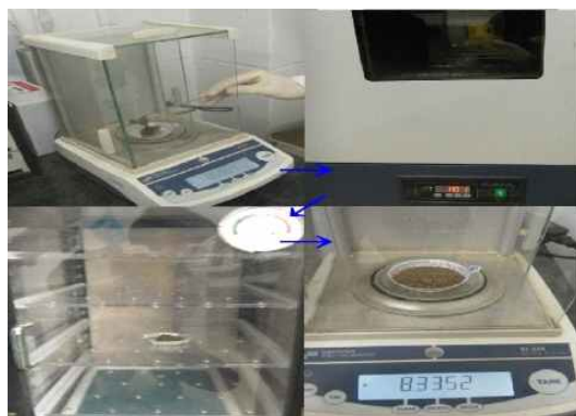
(k) 시료의 수분함유량 측정
