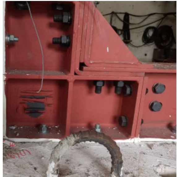
(c) 삼각형 stiffnesser로 보강된 보기둥 접합부(3차년도 실험체(2안))
