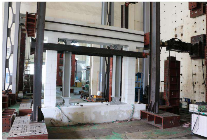
<그림 4.7> Test setup of RC frame retrofitted with column damper
