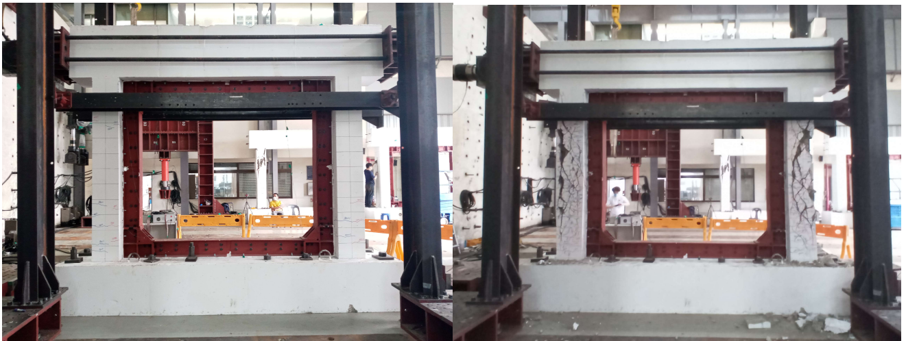
(b) Loading step 1 및 step 9의 3차년도 실험체(2안)-T/L형강 강재프레임 실험사진 <그림 7.4> 3차년도 실험체(2안)-T/L형강 강재프레임 실험사진
