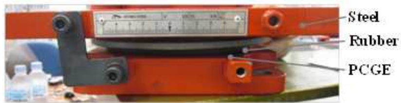
그림 2.2.9 포트 베어링을 이용한 하중 전달 메카니즘
