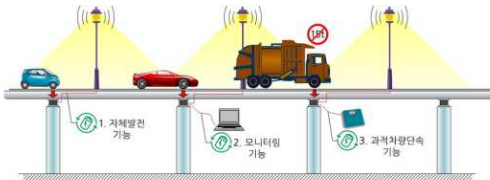
그림 1.1 교량 받침에서 PZT를 이용한 발전 및 모니터링
