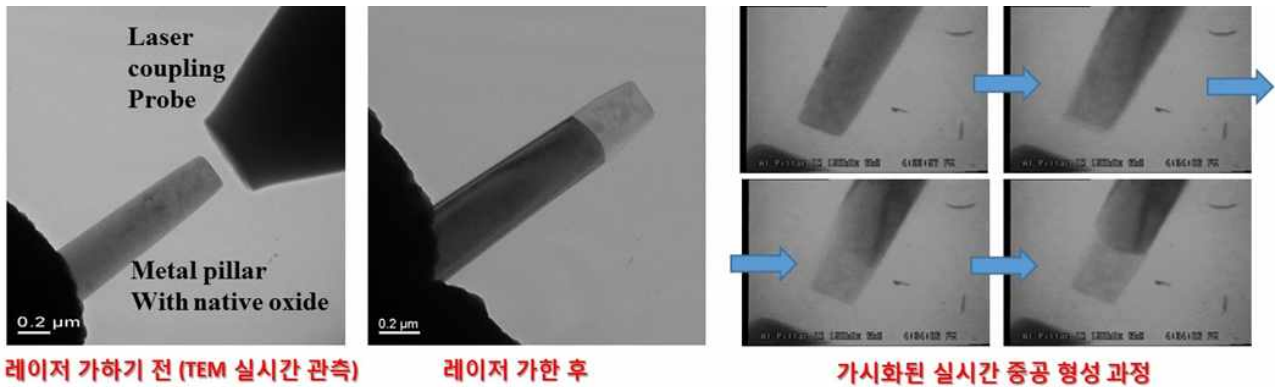
그림 9.8 공동연구책임자가 개발한 관측 장비 (투과전자현미경상에서 실시간으로 레이저 물질 가공과정을 모니터링할 수 있는 시스템)를 이용하여, 새로운 중공 나노입자 생성의 원리를 밝혀낸 실험적 증거; Core에 있는 금속이 레이저로 인해 용융되고 얇은 산화막을 통해 분출된 후, 산화막 기반 중공나노구조가 만들어질 수 있음을 실험적으로 증명함.
