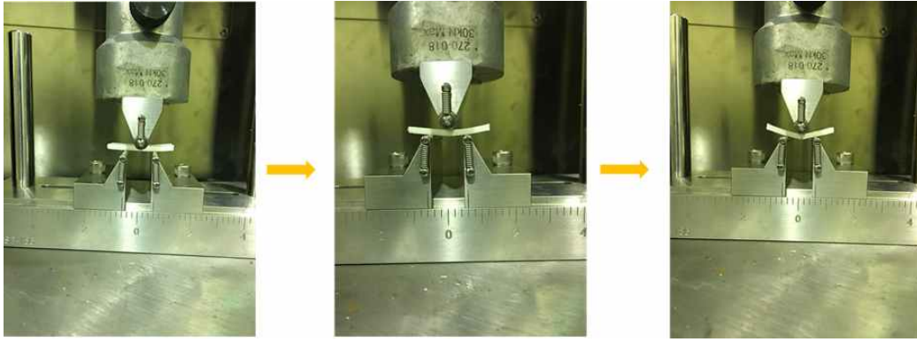
그림 11.31. Layer-by-Layer 공정으로 제작된 단열재의 3 point bending 테스트 장치 및 파손과정
