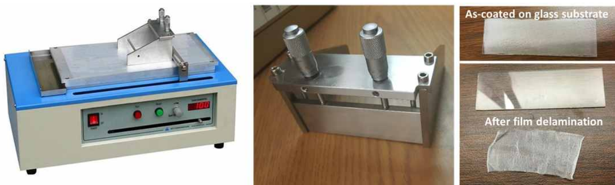
그림 11.6 마이크로 실리카 중공입자와 PMMA 바인더의 혼합물을 Doctor Blade 방식으로 유리기판에 도포한 결과 (기본연구를 위해 상대적으로 얇은 두께를 시도한 결과).
