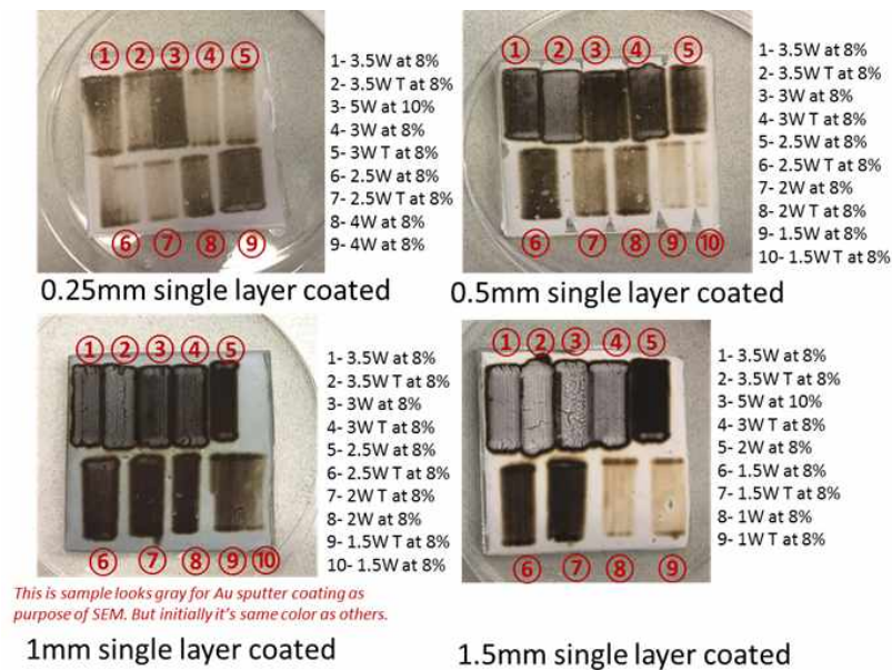
그림 11.34. 단위 Layer 두께에 따른 레이저 흡수 및 가열 정도의 변화 실험 (5mm 직경의 레이저 빔을 동일하게 3 mm/s로 raster-scan 한 결과, 매 라인마다 1mm의 오프셋 부여 조건, K1 입자 +PVDF 기반 샘플)
