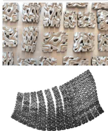
비정형 건축물 시공시 모듈화된 3D 프린팅 콘크리트를 조립하여 쌓아 올려 완성
