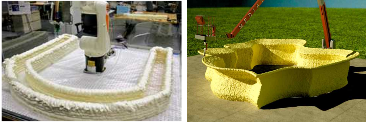
[그림 49] MIT MEDIA LAB 개발된 3D 프린터로 출력한 비정형 거푸집 제작 모습
