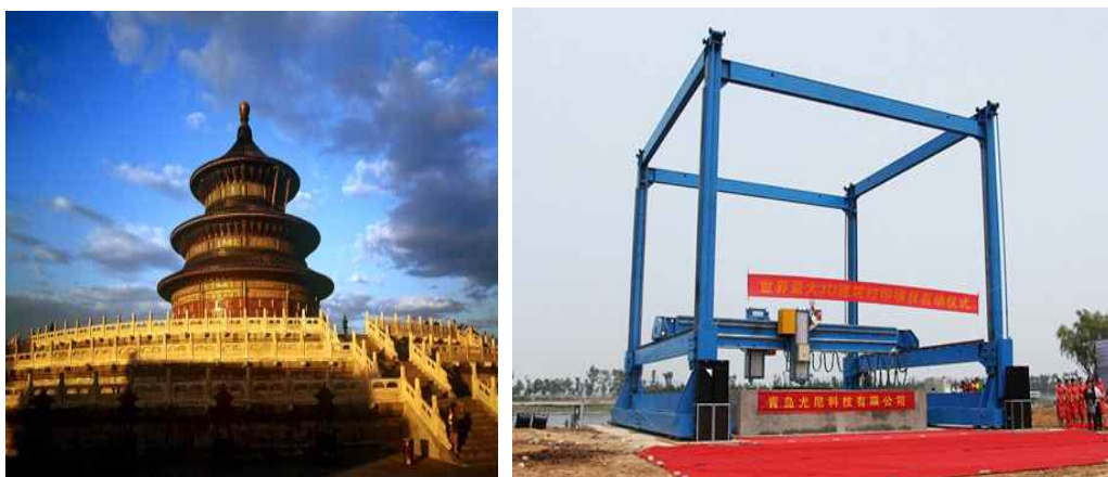
[그림 36] 초대형 3D 프린터를 이용한 중국의 천단 ‘기년전’ 복제 3D 프린팅
