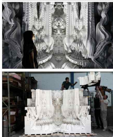
과거 석재 가공으로 제작했던 외벽 장식제를 3D 프린팅으로 대체, 모듈화 하여 조립
