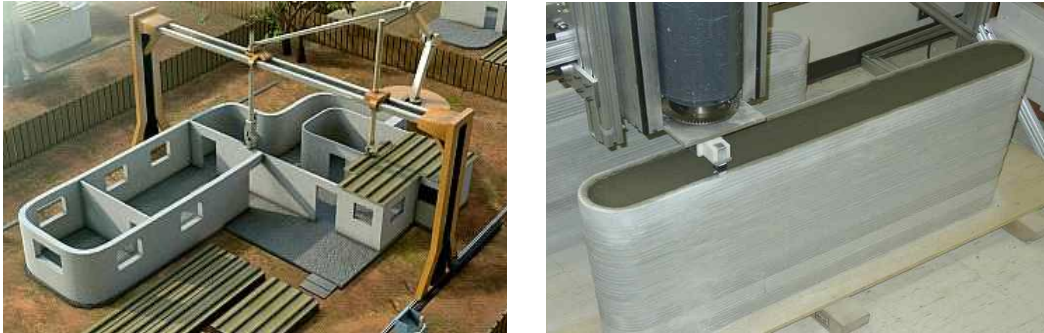
[그림 38] 캘리포니아 대학교(USC)의 초대형 3D 콘크리트 프린팅 'Contour Crafting' 방식
