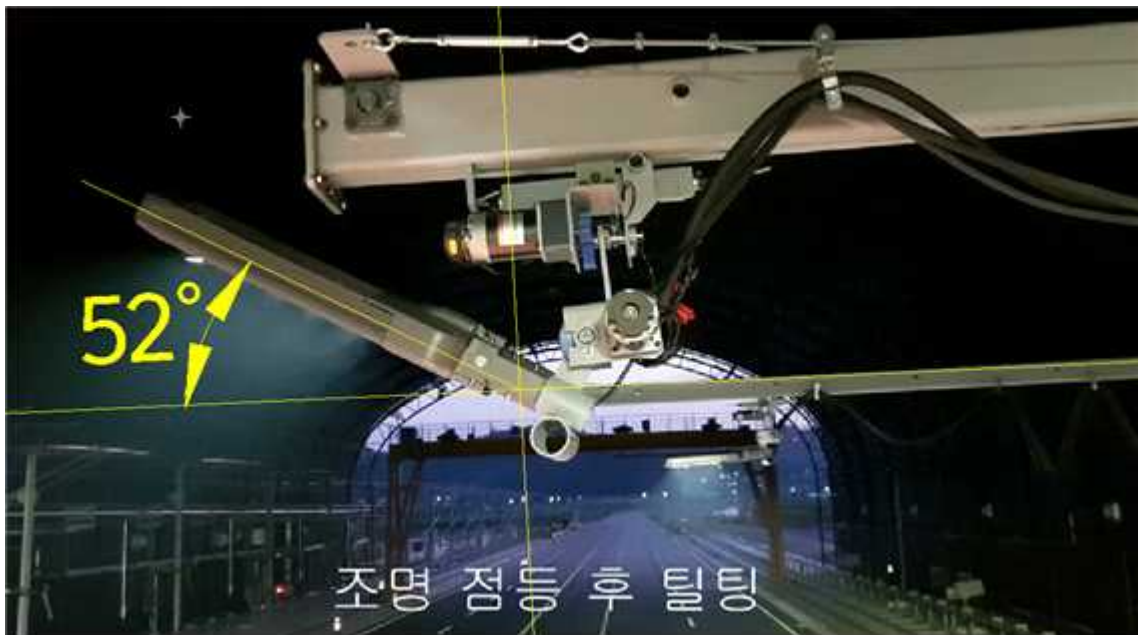
<그림 45> 등기구 틸팅 기능 테스트(상)
