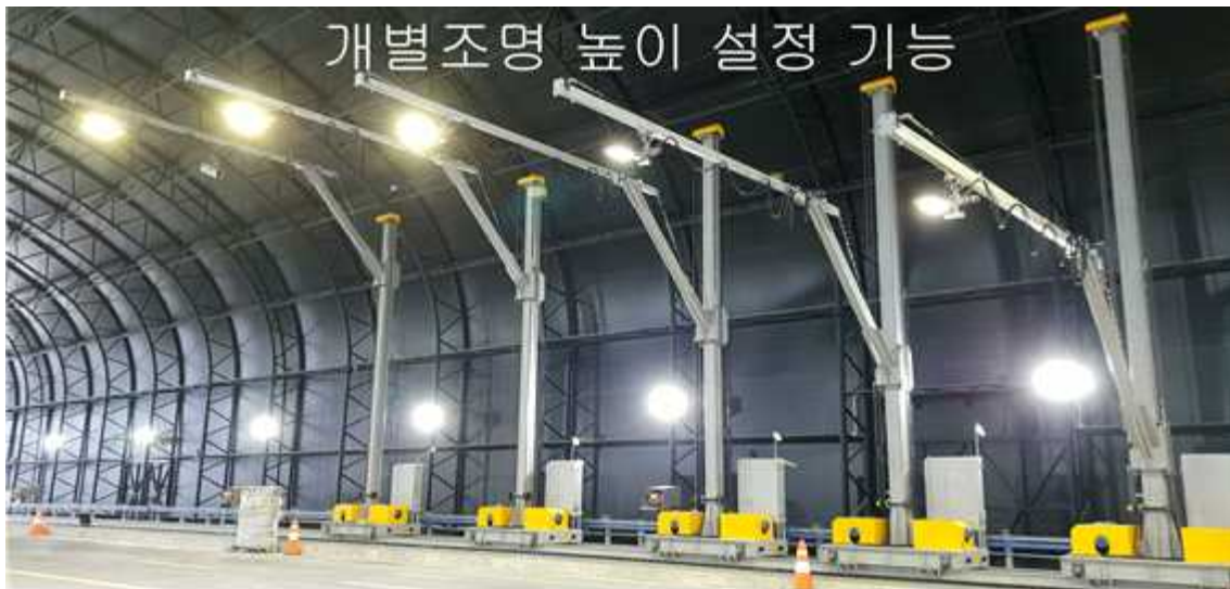
<그림 40> Main post 높이 조절 기능 테스트
