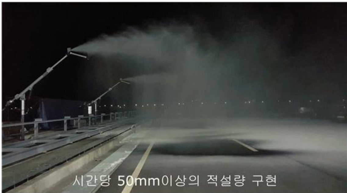
<그림 18> 강설 재현 실험시설 테스트
