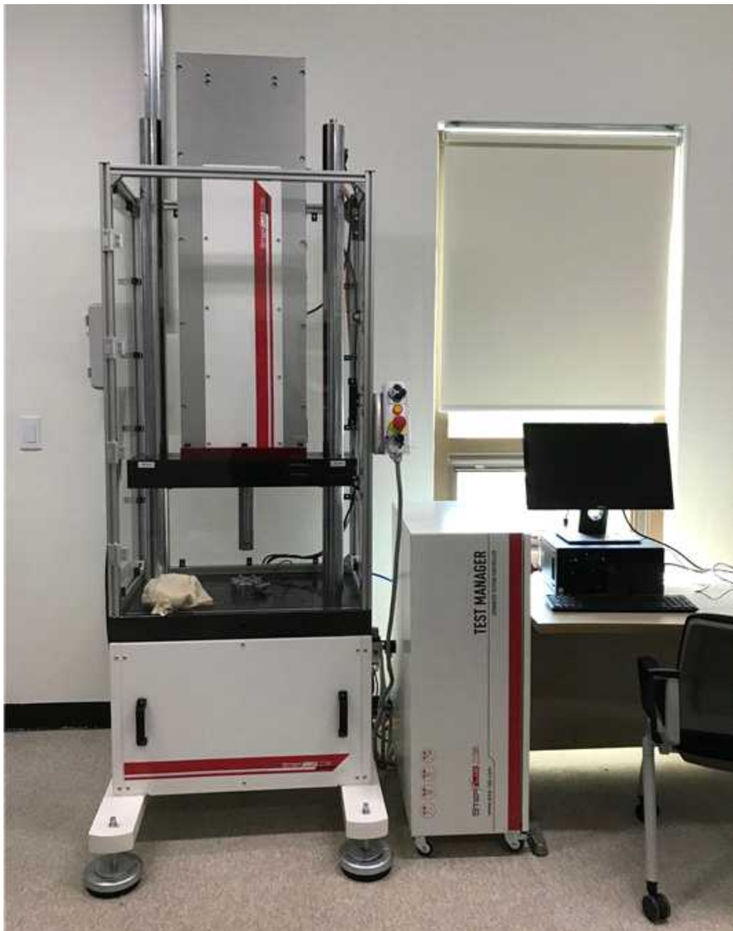
<그림 63> Step Lab UD09 : 압전하베스터 모듈 발전성능 평가장비
