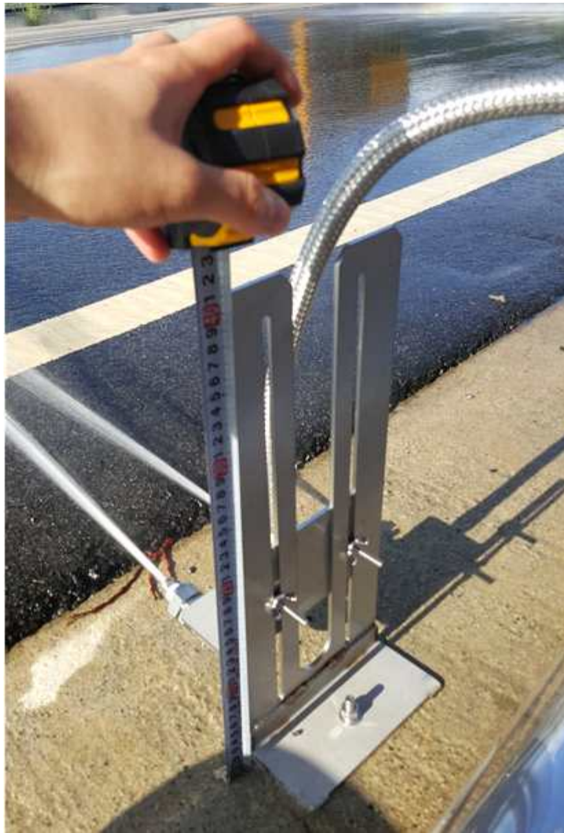
<그림 78> 용설제 성능평가 실험시설 살수높이 조절 테스트
