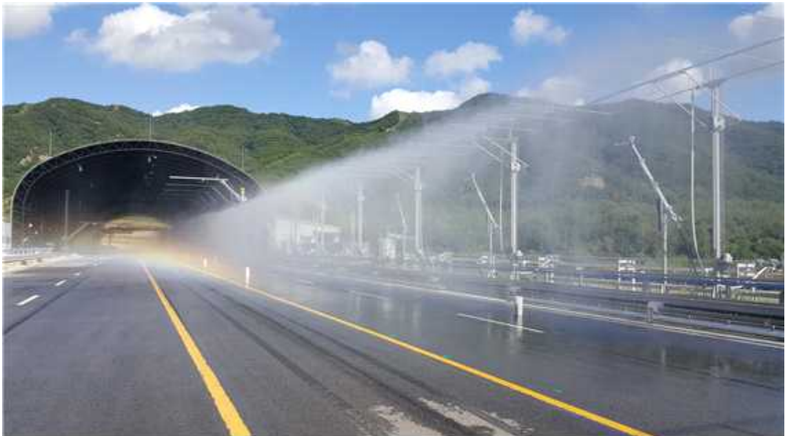
<그림 26> 강우 재현 실험시설 테스트(지상 촬영)
