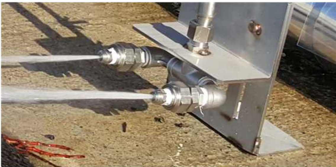
<그림 79> 용설제 성능평가 실험시설 살수각도 조절 테스트
