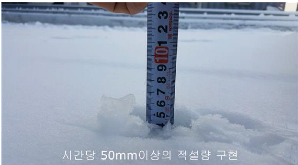
<그림 19> 강설 재현 실험시설 강설량 확인 결과
