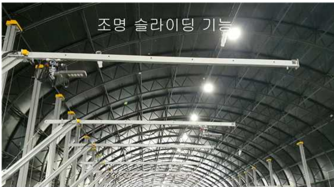
<그림 41> 조명등 위치 조절 기능 테스트(차로 바깥쪽 위치)
