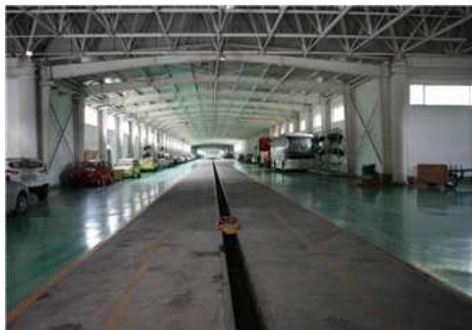
<그림 125> 충돌차량 견인레일과 장치(바닥)
