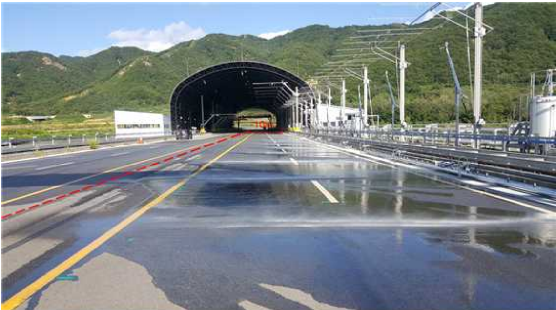
<그림 81> 용설제 성능평가 시험시설 분사거리 테스트
