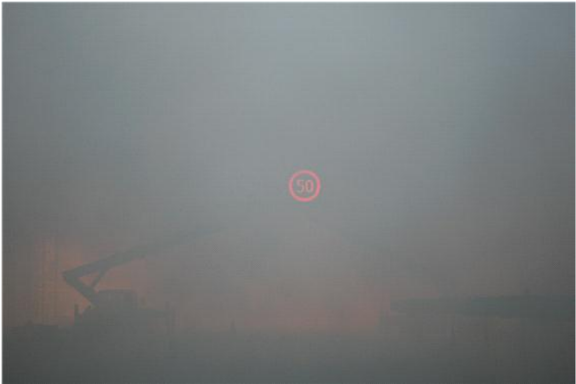
<그림 33> 안개 재현 실험시설 테스트
