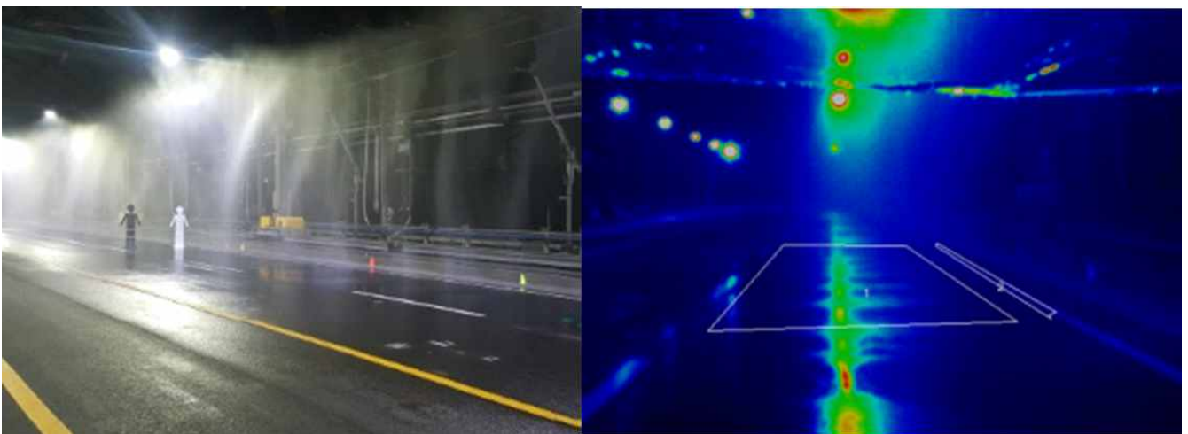
<그림 113> 악천후시 상황 구현(좌), 노면 휘도 측정 결과(우)
