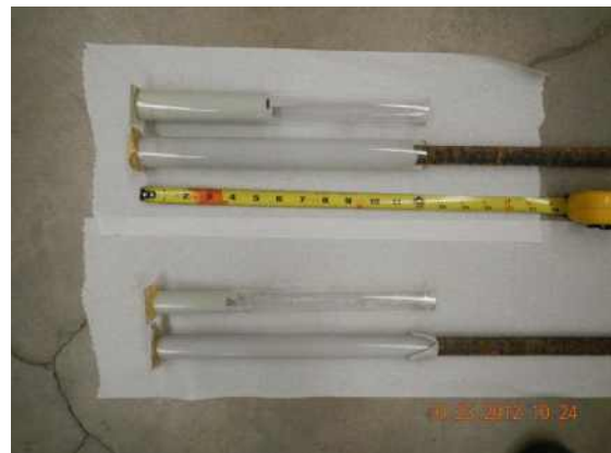
(b) 에폭시 주입 후 철근 삽입 설치(o)
