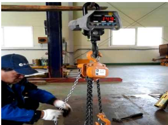
<그림 3.4> 콘크리트 무게 모사 시험
