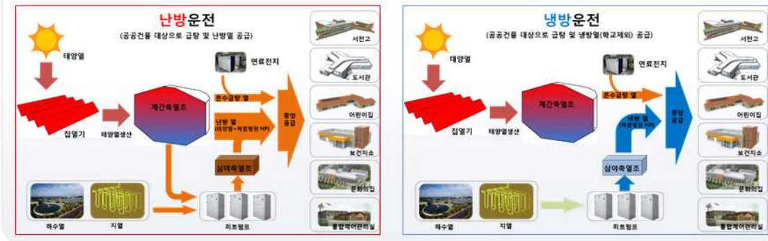
[그림 2-96] 진천 친환경에너지타운 신재생에너지기반 열공급 개념도
