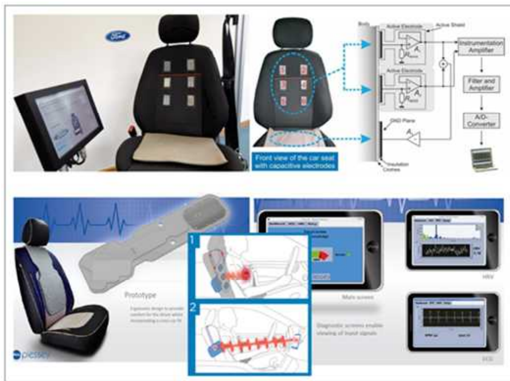
[그림 7] 운전자 심장활동 모니터링을 위한 시트형태의 측정 장치 Ford사의 프로토타입 시트(위), plessey사의 프로토타입 시트(아래)
