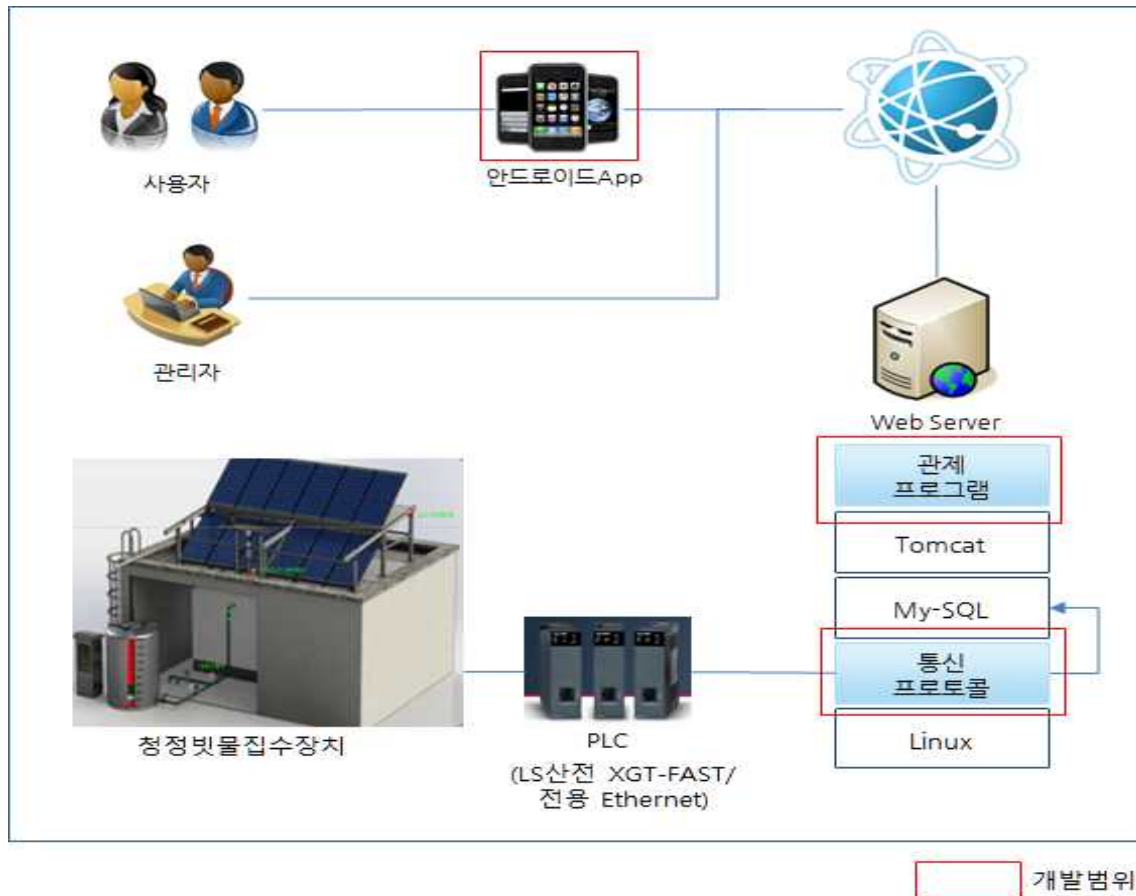
그림 3.11 원격모니터링 시스템 구성도
