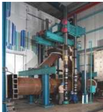
〈대용량 UTM을 이용한 원형 구조물 성능 실험〉
