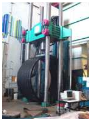
〈대용량 UTM을 이용한 원형 구조물 성능 실험〉
