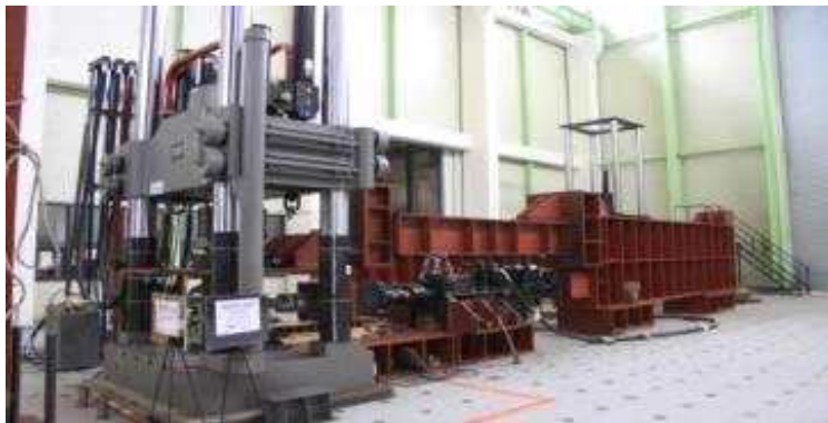
〈5MN 일체형 UTM을 이용한 마찰진자받침 성능실험〉
