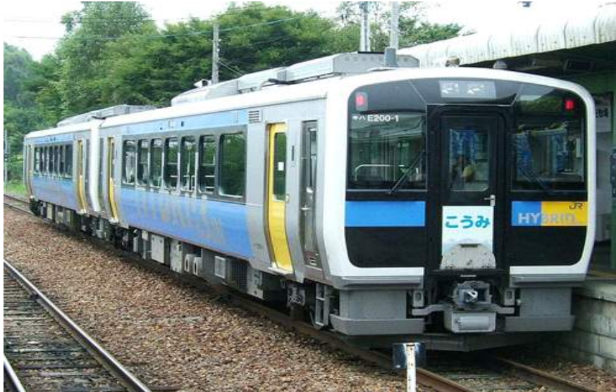
그림 4 Li-ion 배터리를 탑재한 하이브리드 디젤전동차
