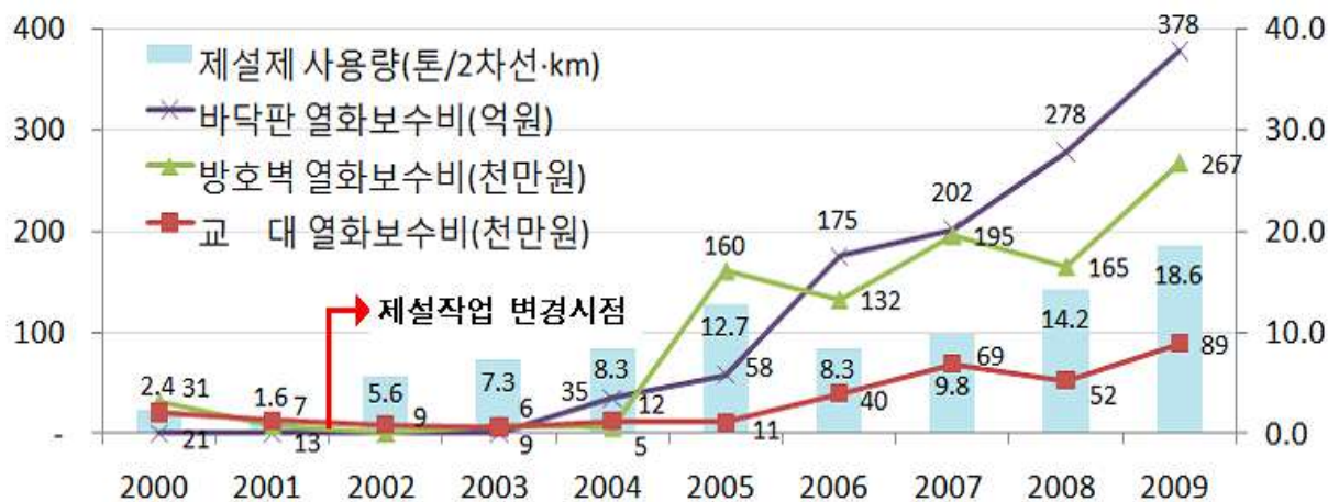
그림 1.8 제설제 사용량 및 바닥판, 교대, 방호벽 열화 보수비용 현황 <출처 : 도로교통연구원 (2010)>
