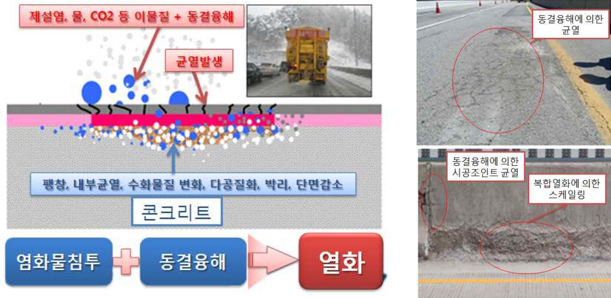
그림 1.4 콘크리트 포장 복합열화 메커니즘과 열화현황
