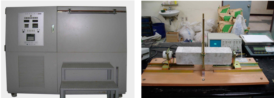
그림 2.31 급속동결융해 시험기 및 상대동탄성계수 측정
