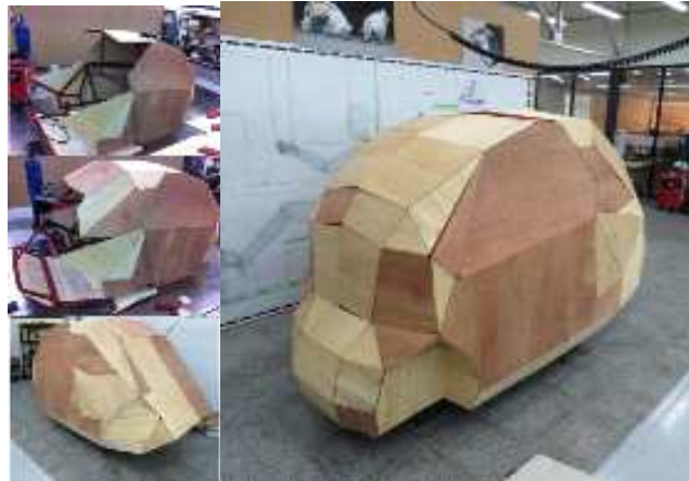
<그림> 클레이 모델 제작을 위한 내부 골조
