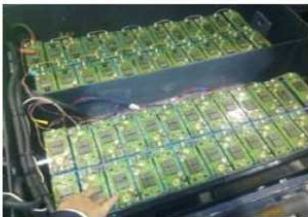
<그림> 배터리 셀 배치 및 결선을 포함한 케이싱
