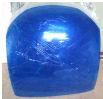
<그림> 폴리카보네이트 성형 및 모서리 다듬기 완료
