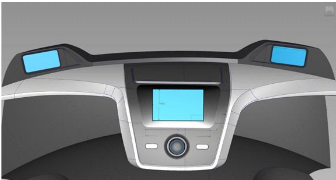
<그림> 메인 디스플레이 및 사이드 미러용 디스플레이 구성
