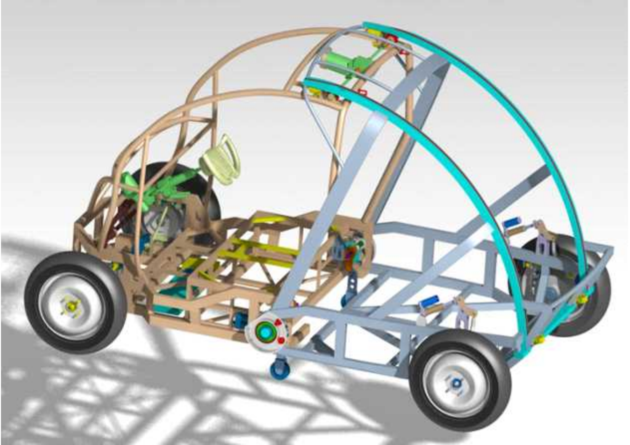
<그림> 초소형 접이식 전기자동차 차체 프레임
