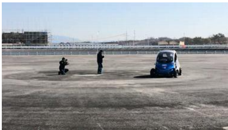
<그림> 대구 지능형 자동차 부품 주행시험장, 원선회 시험
