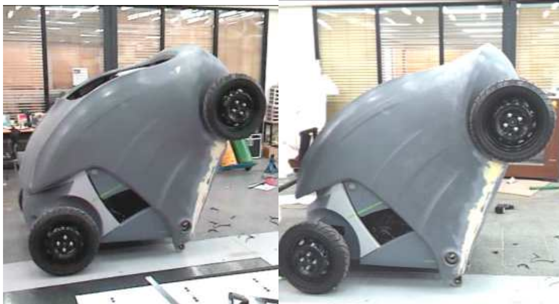
<그림> 차량 가조립 및 점검 (접힌 상태)
