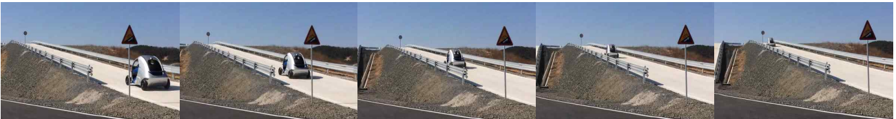
<그림> 등판성능 시험 시 차량의 움직임
