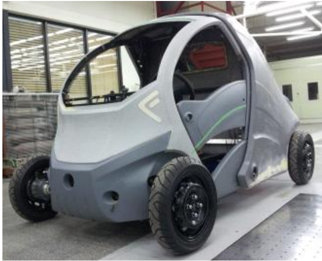
<그림> 차량 가조립 및 점검
