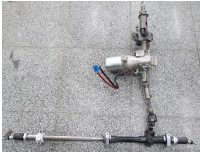
〈그림〉 조향장치 및 조향 모터 어셈블리
