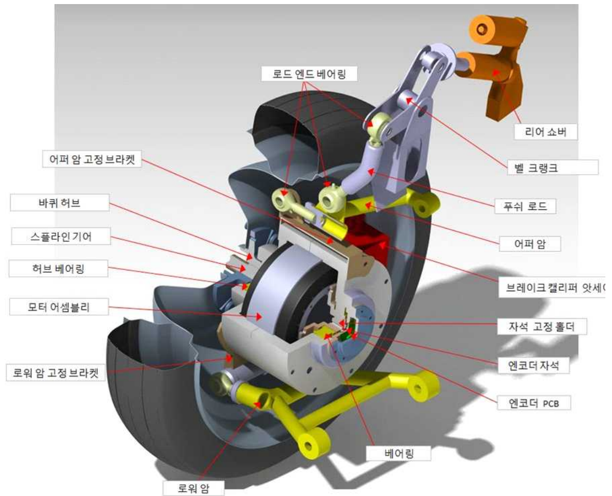
<그림> 인휠 구동시스템 후륜 어셈블리
