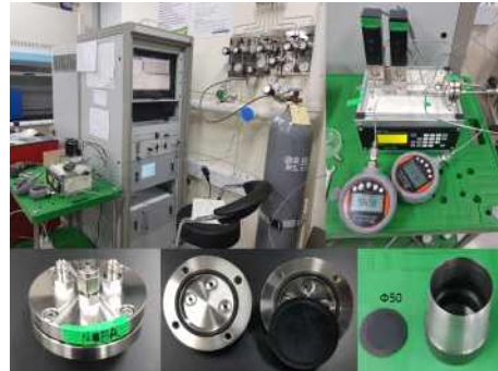
[수소 투과도 시험 장치의 구성도와 실제 사진]
