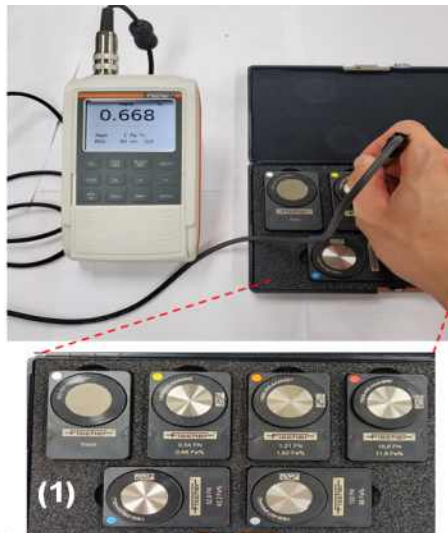
[페라이트 성분의 비파괴식 측정을 위한 Probe의 Calibration 광경]
