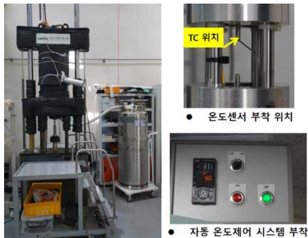
[SSRT 시험 시스템 개조]
