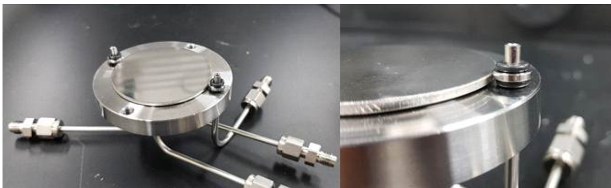
[등압 수소 투과도 셀의 유로 및 누출 방지용 오링 사진]
