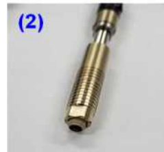
[페라이트 성분의 비파괴식 측정을 위한 Probe의 Calibration 광경]
