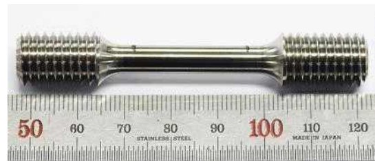
[인장 시험편 도면 및 가공된 시험편]
