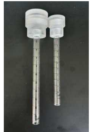
[수소 기체 부피 측정을 위해 자체 제작한 눈금 실린더]
