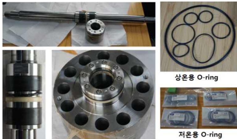
[SSRT 시험 시스템의 저온용 O-ring 교체]
