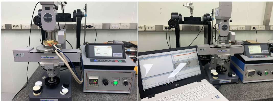
[고온경도 측정 시스템(좌) 및 히스테리시스(hysteresis, 경도 복원율) 측정 시스템(우)]
