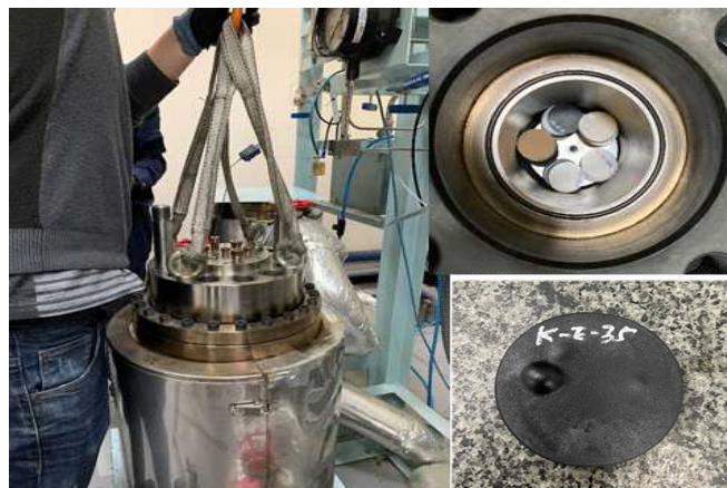
[EPDM 수소용 쉘 후보 소재 수소 주입 모습(전용 장비 포함)과 수소가 주입되어 표면이 부풀어 오른 모습(시료 기호: K-E-3)]
