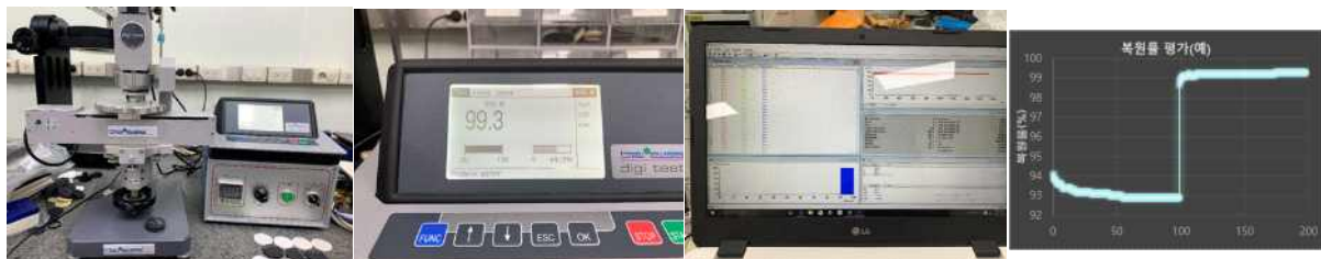
[히스테리시스(hysteresis, 경도 복원율)을 측정 시스템]
