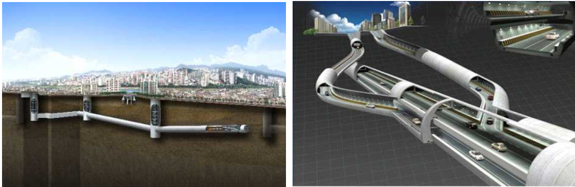
〈 그림 3.16 〉 TBM 굴착 기술과 복층터널 개념도
