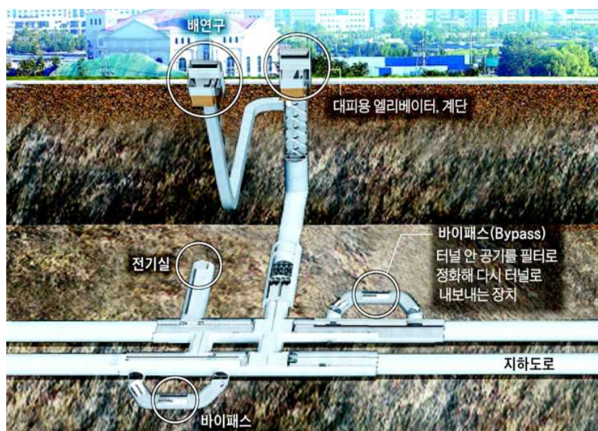
< 그림 1.17 > 도시지역 지하도로 바이패스(Bypass) 설치 개념도
