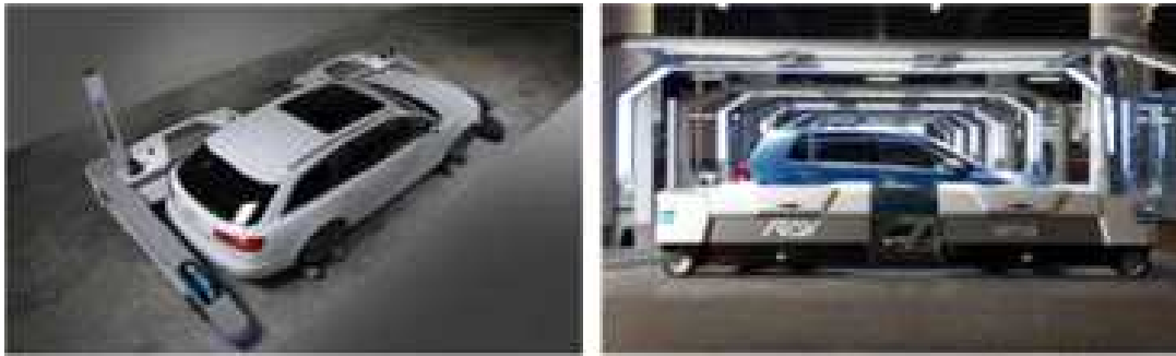
〈 그림 2.51 〉 독일 Serva Transport Systems사의 Ray 자동 주차 시스템
