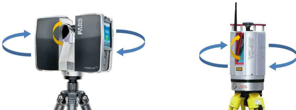
그림 4. 대부분의 지상 라이다 시스템은 레이저 광선 수직방향 제어시 내장된 회전거울을 이용하나, 수평 방향 제어시 장비 자체가 회전하므로 속도가 느리다 (왼쪽: FARO Focus3D, 오른쪽: RIEGL VZ-400).
