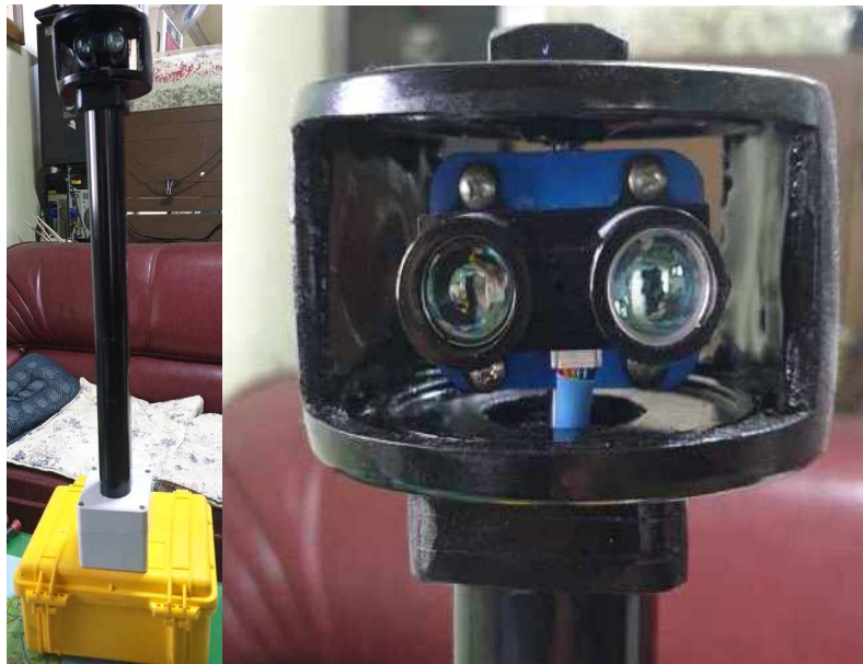
그림 46 장애물 탐지 센서 네트워크 시스템 하드웨어 제작 결과
