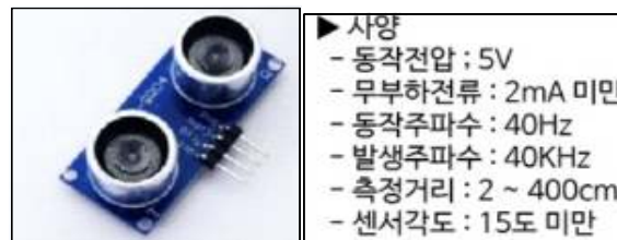
그림 22 초음파 거리측정 센서 사례
