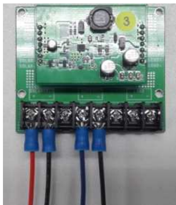
그림 43 Automatic Charging System PCB 제작 결과
