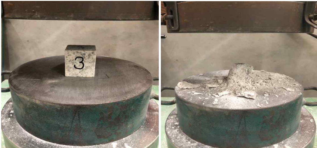
사진 32. 시험체 압축강도 시험
