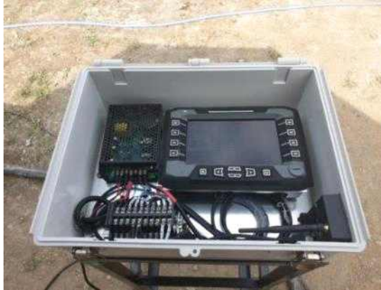
사진 51. RPM 및 와이어쏘 장력 측정
