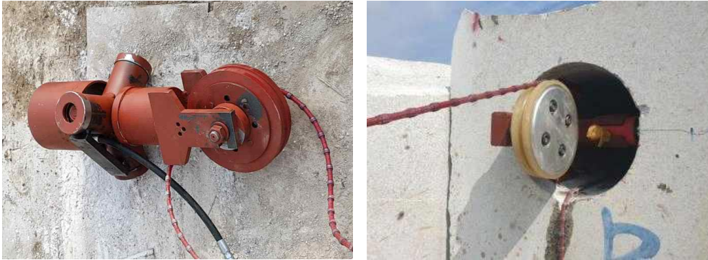
사진 49. 종방향 암반절단 기술용 앵커사진 및 성능평가
