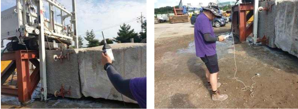
사진 52. 소음 및 진동 측정 방법
