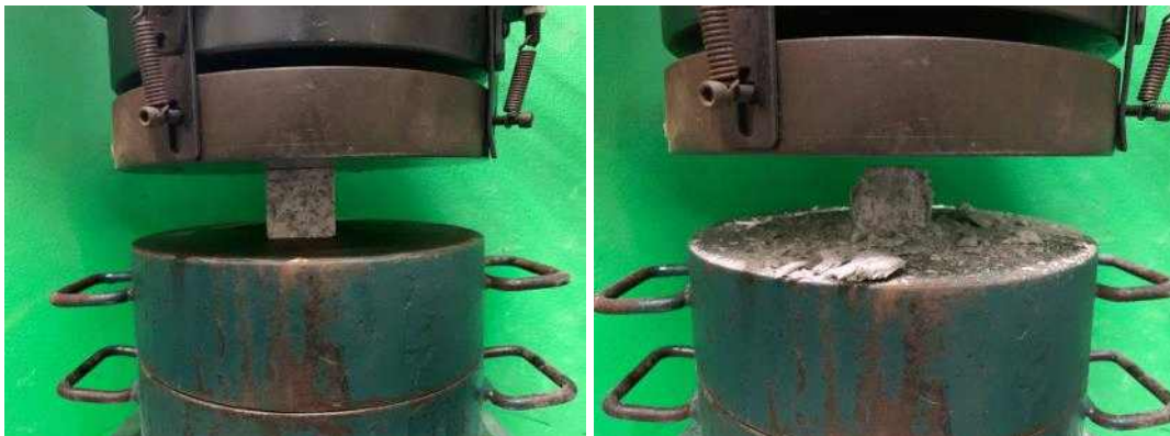
사진 33. 시험체 압축강도 시험
