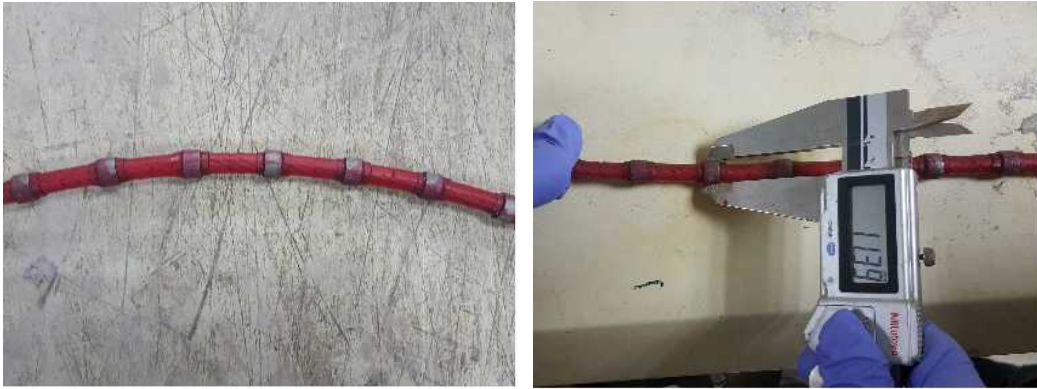
사진 48. 비드마모량 측정 방법
