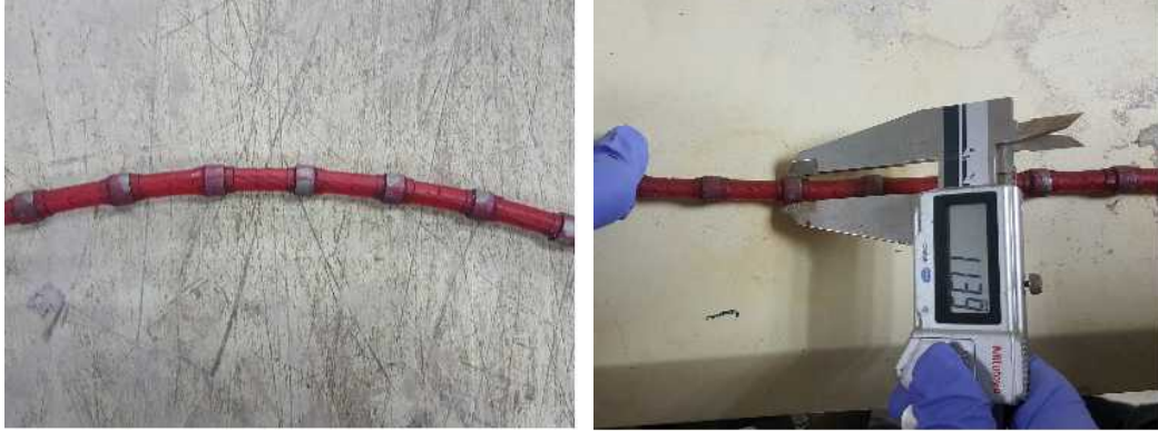
사진 41. 비드마모량 측정 방법
