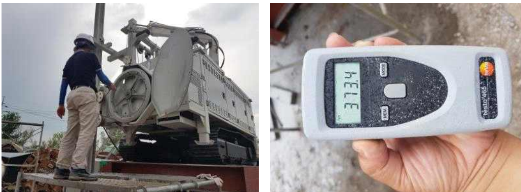
사진 50. 장비(메인 폴리) RPM 측정 방법
