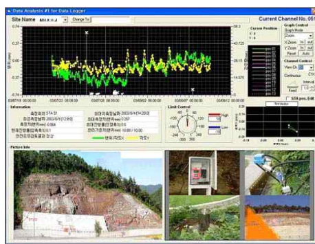
[그림] 도로절토사면 유지관리시스템 및 계측기 설치 모식도
