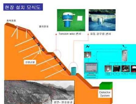
[그림] 도로절토사면 유지관리시스템 및 계측기 설치 모식도
