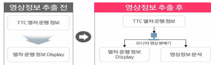
<그림-67> 영상정보 추출 전/후 시스템 구성비교
