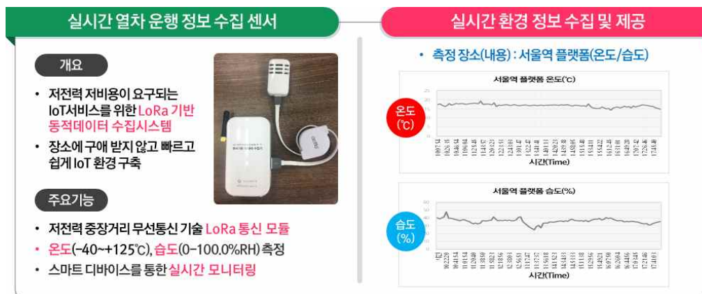
<그림-26> IoT 로라(LoRa) 통신 모듈 적용 동적 데이터 수집기술 연구개발
