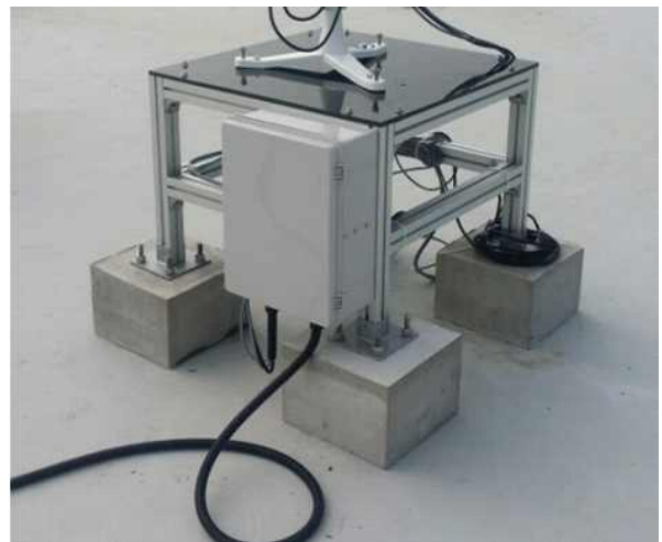
(그림 75) 전일사량, 직달일사량 실측 모습(성균관대학교 수원캠퍼스)
