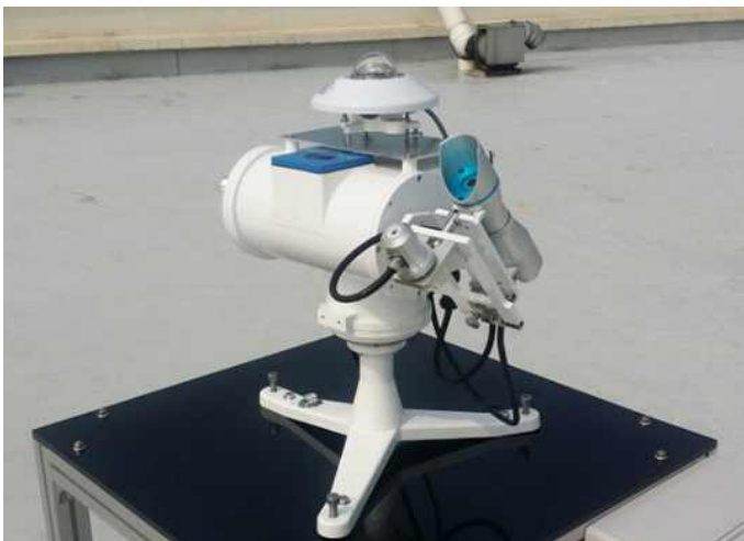
(그림 75) 전일사량, 직달일사량 실측 모습(성균관대학교 수원캠퍼스)
