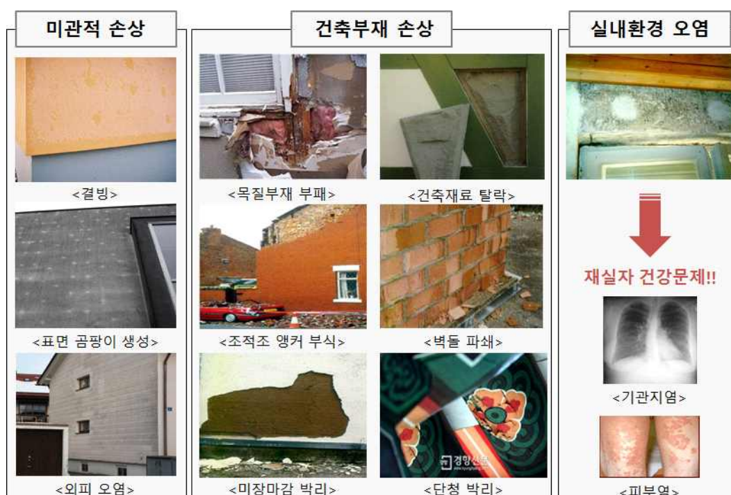
(그림 80) 기후환경에 따른 건축물 실내·외 하자 발생 사례
