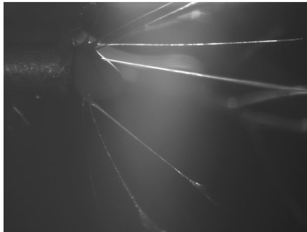
그림 75. Multi-nozzle에서 방사되는 다수의 spinneret
