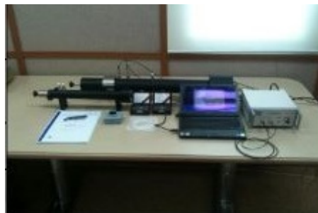
그림 48. 본 연구에서 활용한 흡음 계수 측정용 '임피던스 튜브' 기기의 실제 사진
