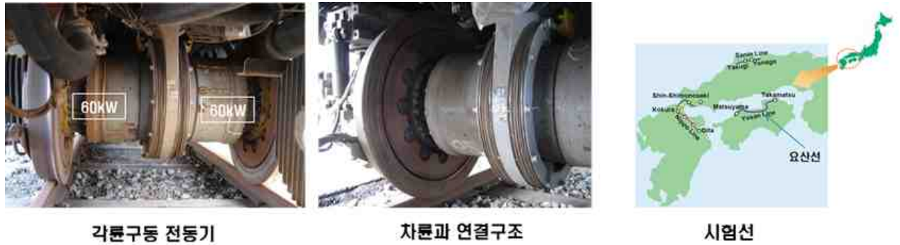
[그림 46] RTRI의 궤간가변 차량 적용 각률큐동 전동기
