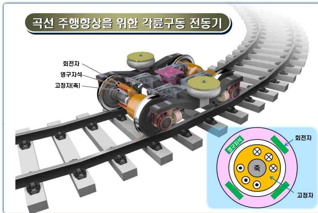
[그림 14] 각륵구동전동기의 개념 및 적용 예
