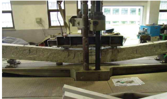
그림 2 화재 피해를 입은 콘크리트 보 부재의 가력 실험
