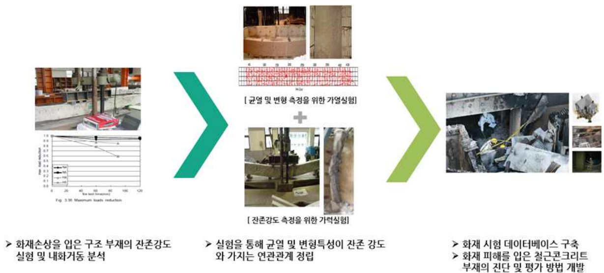
그림 17 화재 피해를 입은 철근 콘크리트 부재의 구조성능 평가분야의 2차년도 연구개요
