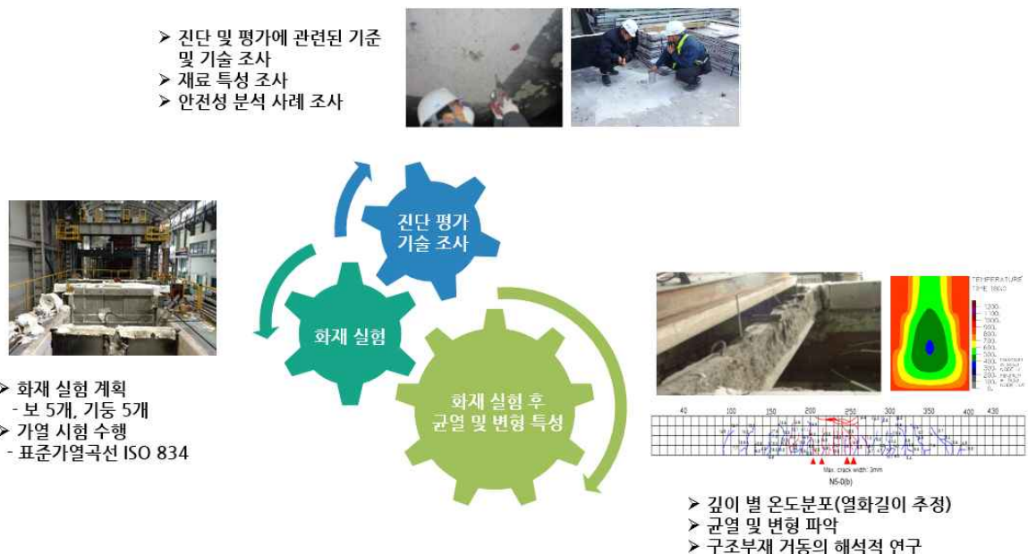
그림 15 화재 피해를 입은 철근 콘크리트 부재의 구조성능 평가분야의 1차년도 연구개요
